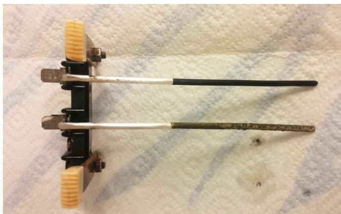
Slika 8. Elektrode nakon provedene elektrolize
