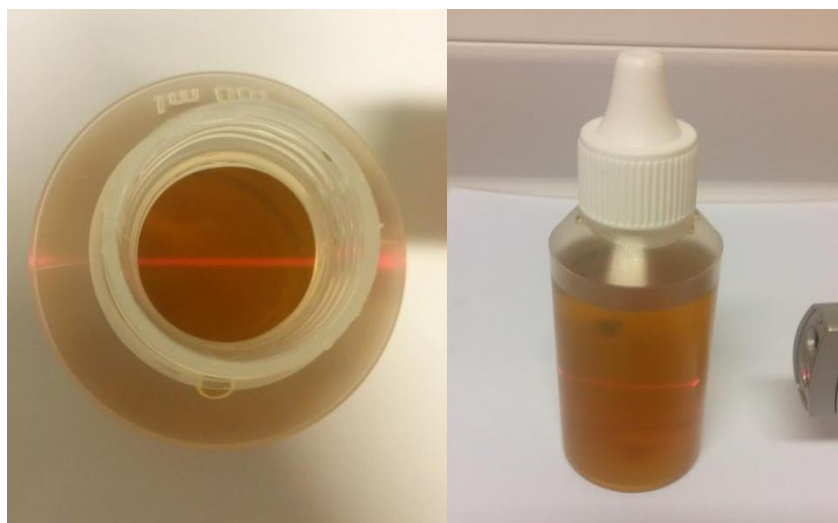
Slika 12. Provjera pojave Tyndallovog efekta u sintetiziranom uzorku koloidnog srebra, pogled odozgo i sa strane
