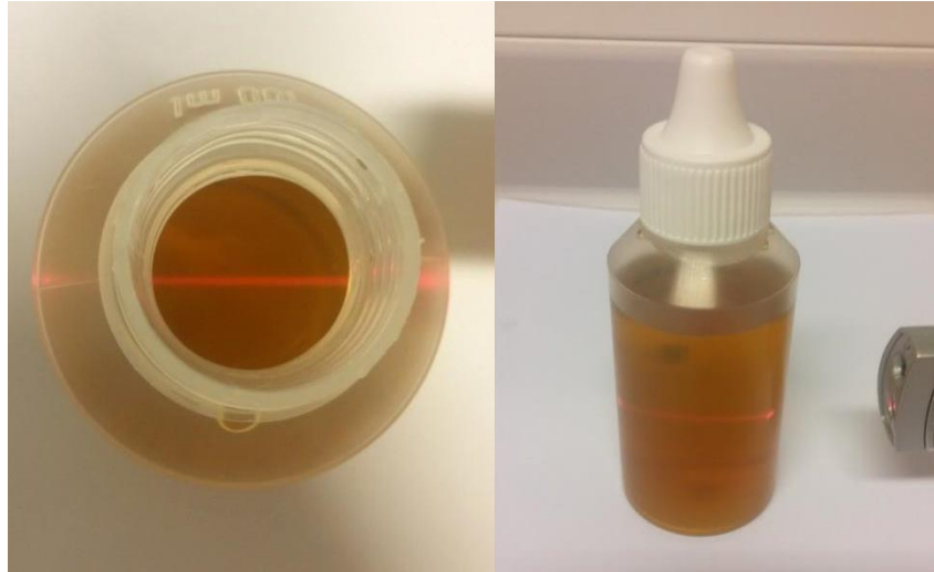
Slika 12. Provjera pojave Tyndallovog efekta u sintetiziranom uzorku koloidnog srebra, pogled odozgo i sa strane
