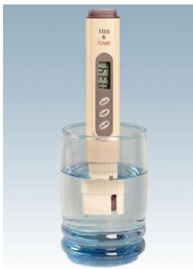
Slika 5. Instrument za mjerenje ukupno otopljenih krutina u vodi, TDS metar 12
