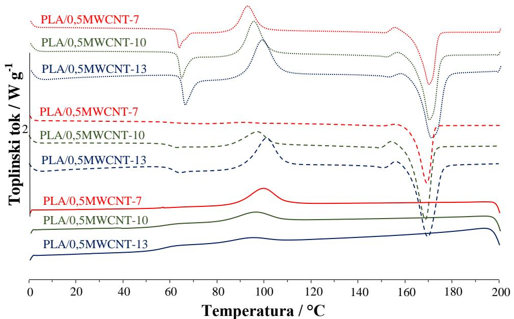
**Slika 23.** DSC krivulje prvog zagrijavanja, hlađenja i drugog zagrijavanja PLA/0,5MWCNT kompozita snimljene pri brzinama zagrijavanja/hlađenja 7, 10 i  $13 \text{ }^{\circ}\text{C min}^{-1}$
