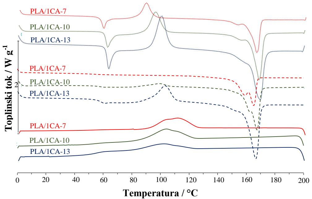
**Slika 21.** DSC krivulje prvog zagrijavanja, hlađenja i drugog zagrijavanja PLA/1CA kompozita snimljene pri brzinama zagrijavanja/hlađenja 7, 10 i  $13 \text{ }^{\circ}\text{C min}^{-1}$
