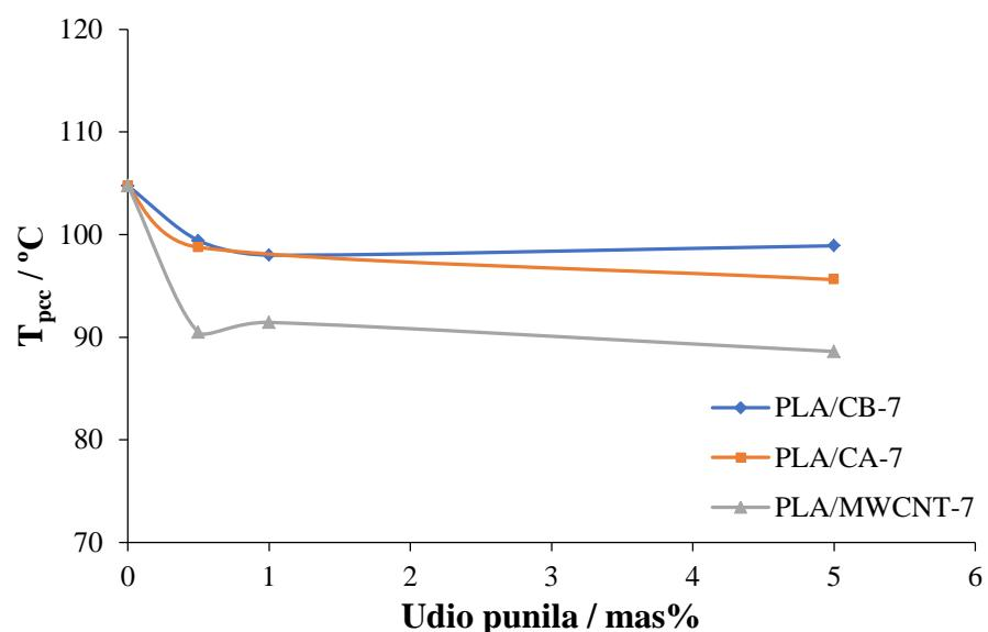
**Slika 35.** Ovisnost  $T_{pcc}$  o udjelu CB, CA i MWCNT u PLA kompozitima nakon drugog zagrijavanja brzinom  $7\text{ }^{\circ}\text{C min}^{-1}$
