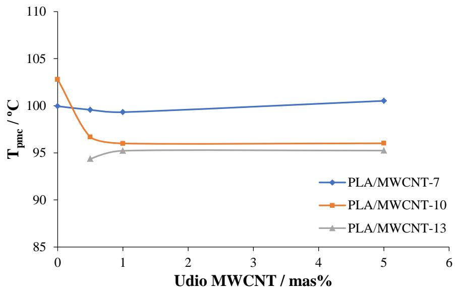
**Slika 28.** Ovisnost  $T_{\text{pmc}}$  o udjelu MWCNT u PLA kompozitu nakon hlađenja brzinom 7, 10 i  $13 \text{ }^{\circ}\text{C min}^{-1}$
