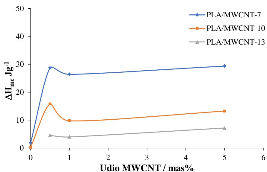
**Slika 31.** Ovisnost  $\Delta H_{mc}$  o udjelu MWCNT u PLA kompozitu nakon hlađenja brzinom 7, 10 i  $13\text{ }^{\circ}\text{C min}^{-1}$
