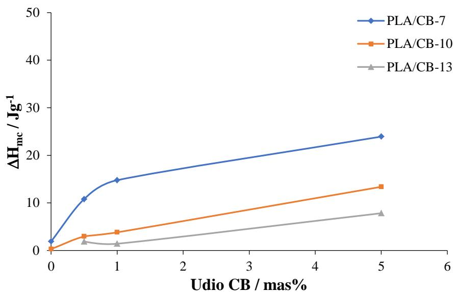
**Slika 29.** Ovisnost  $\Delta H_{\text{mc}}$  o udjelu CB u PLA kompozitu nakon hlađenja brzinom 7, 10 i  $13 \text{ }^{\circ}\text{C min}^{-1}$
