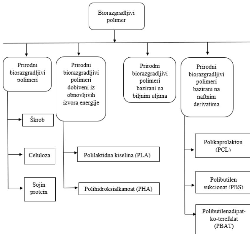
**Slika 2.** Shematski prikaz podjele biorazgradljivih polimera s obzirom na podrijetlo<sup>8</sup>
