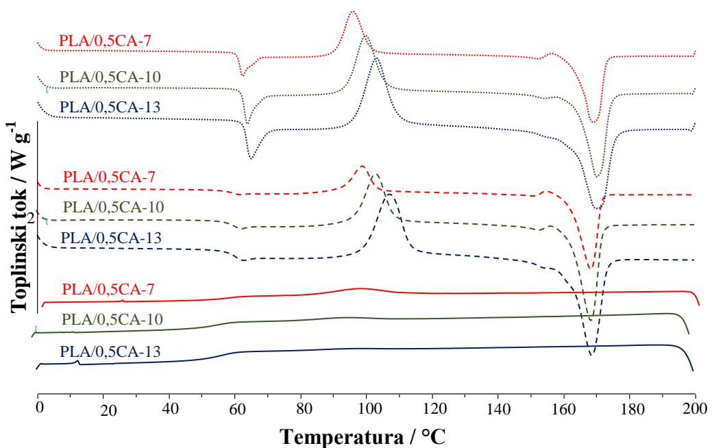
**Slika 20.** DSC krivulje prvog zagrijavanja, hlađenja i drugog zagrijavanja PLA/0.5CA kompozita snimljene pri brzinama zagrijavanja/hlađenja 7, 10 i  $13 \text{ }^{\circ}\text{C min}^{-1}$
