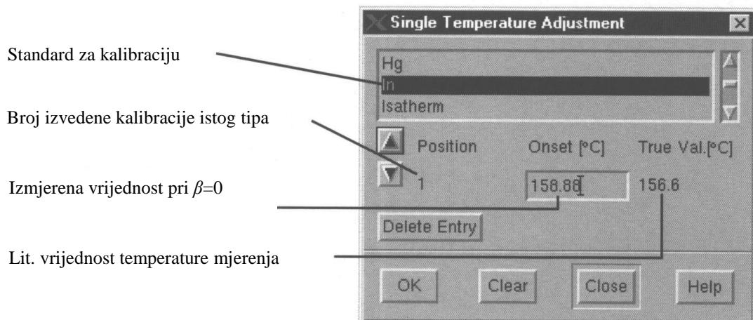
**Slika 13.** Dijaloški okvir podešavanja temperature nakon kalibracije DSC 823<sup>e26</sup>
