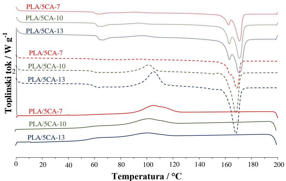
**Slika 22.** DSC krivulje prvog zagrijavanja, hlađenja i drugog zagrijavanja PLA/5CA kompozita snimljene pri brzinama zagrijavanja/hlađenja 7, 10 i  $13 \text{ }^{\circ}\text{C min}^{-1}$
