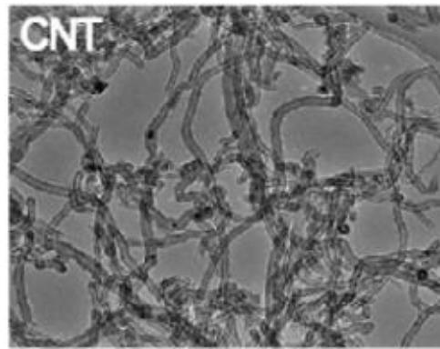
Slika 8. Mikroskopski prikaz CNT-a<sup>13</sup>
