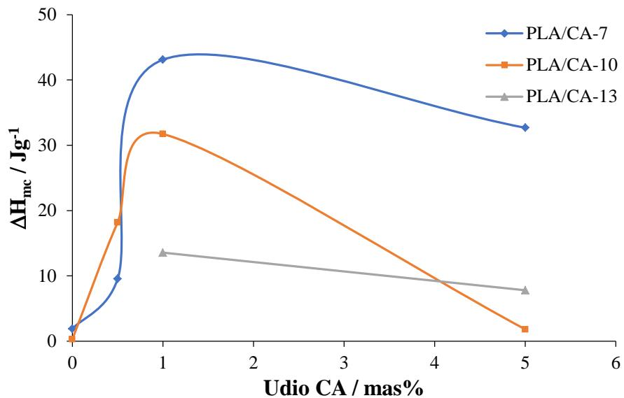
**Slika 30.** Ovisnost  $\Delta H_{mc}$  o udjelu CA u PLA kompozitu nakon hlađenja brzinom 7, 10 i  $13\text{ }^{\circ}\text{C min}^{-1}$
