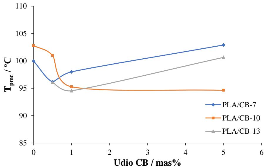
**Slika 26.** Ovisnost  $T_{\text{pmc}}$  o udjelu CB u PLA kompozitu nakon hlađenja brzinom 7, 10 i  $13 \text{ }^{\circ}\text{C min}^{-1}$
