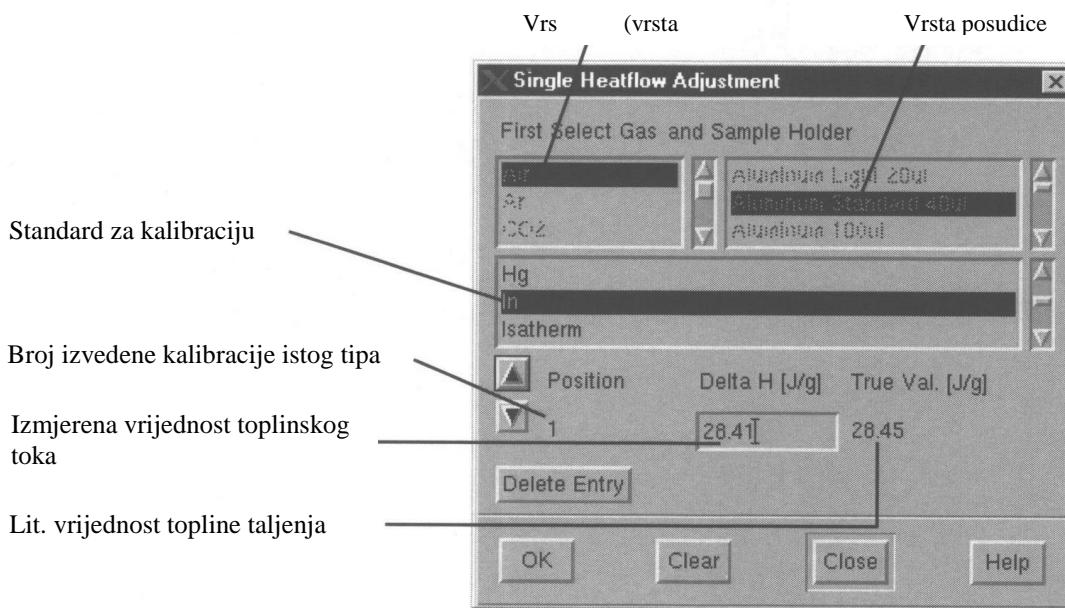
**Slika 14.** Dijaloški okvir podešavanja toplinskog toka nakon kalibracije DSC 823<sup>e26</sup>
