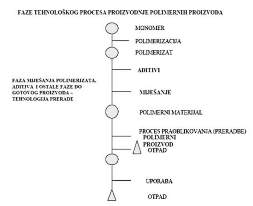
Slika 1. Faze tehnološkog procesa proizvodnje polimernih proizvoda 3
