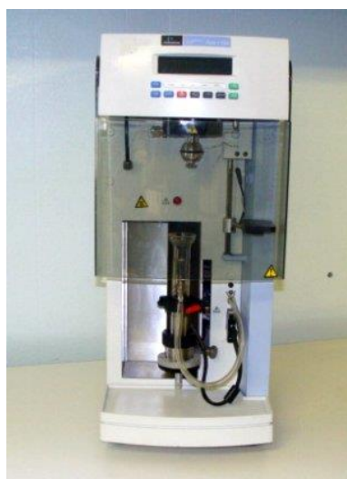
Slika 15. Termogravimetar Pyris 1 TGA (Perkin-Elmer, SAD).
