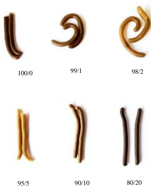
Slika 18. Uzorci mješavina PVC/ES dobiveni ekstrudiranjem pri 170 °C.
