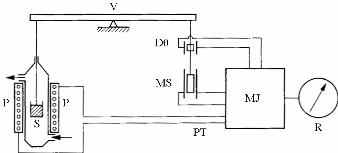
**Slika 10.** Shema TG uređaja: V - vaga, S - uzorak, P - peć, PT – programiranje temperature, D0 - detektor nulte točke, MS - magnetski svitak za kompenzaciju mase, MJ - modularna jedinica, R - registracijski uređaj.<sup>40</sup>
