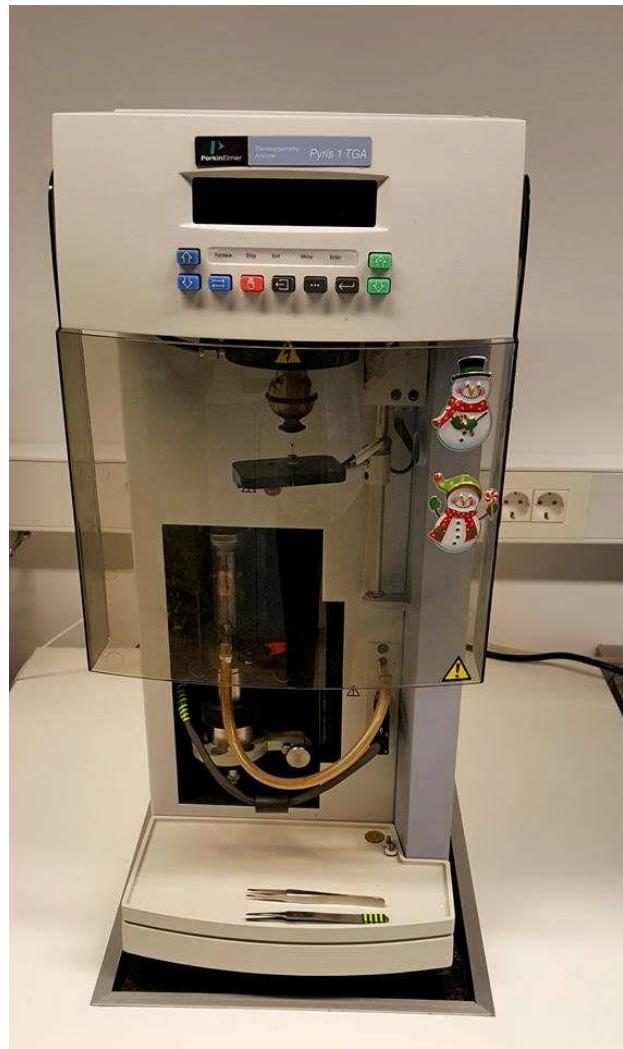
**Slika 15.** Termogravimetar Pyris 1 TGA
