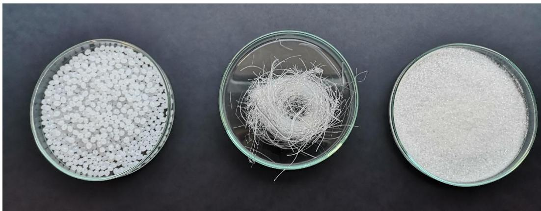
**Slika 14.** Granule, vlakna, prah PLA-a
