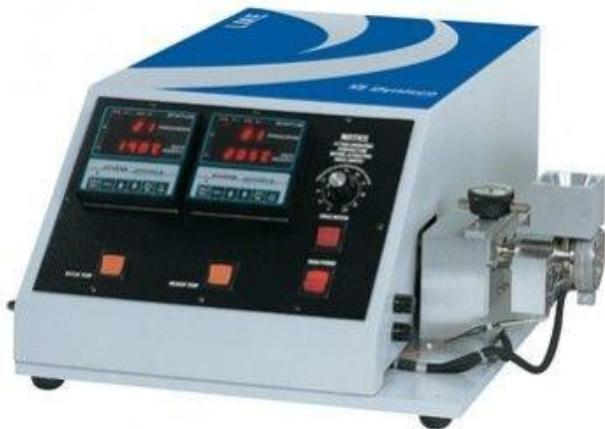
**Slika 13.** Jednopužni laboratorijski ekstruzer DYNISCO LME 230
