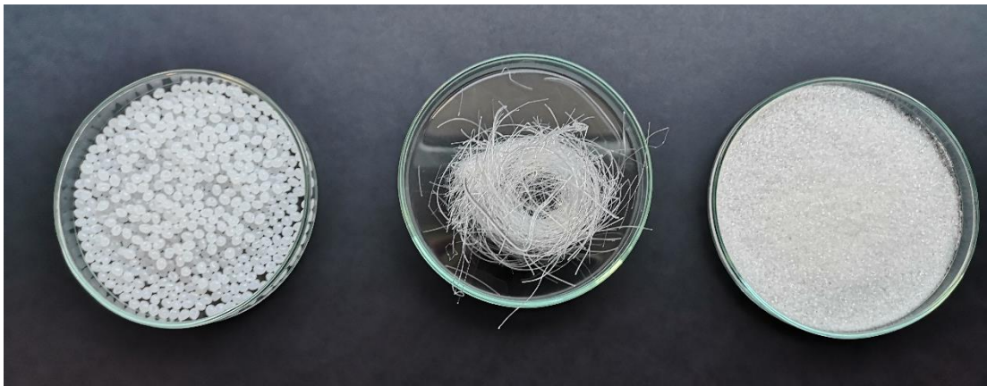
Slika 14. Granule, vlakna, prah PLA-a
