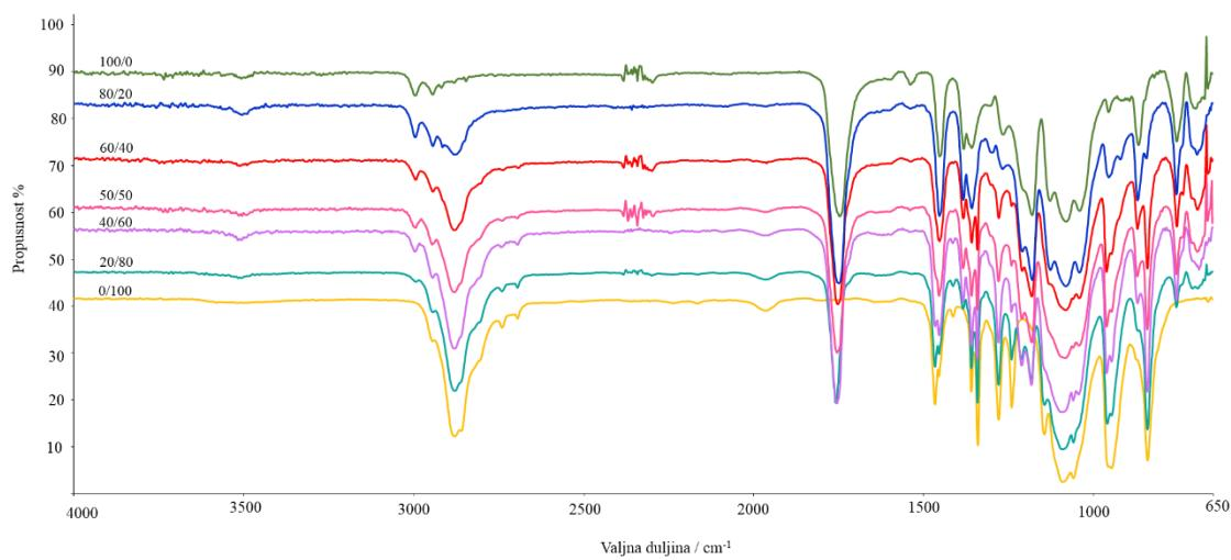
**Slika 33.** FTIR spektrogrami mješavina PLA/PEO svih sastava
