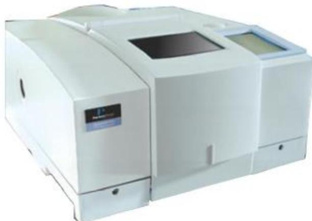
**Slika 15.** FTIR spektrometar Spectrum One (PerkinElmer, SAD)
