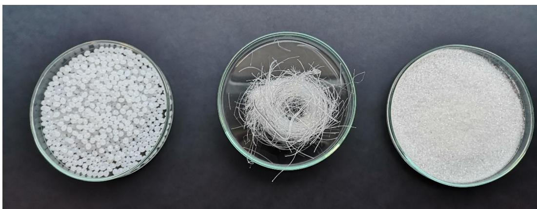
**Slika 13.** Granule, vlakna, prah PLA-a
