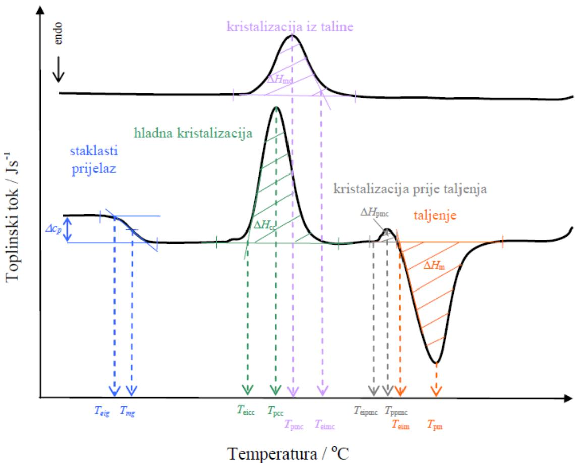
Slika 8. Opći prikaz DSC termograma i podataka koji se iz njega mogu odrediti<sup>54</sup>
