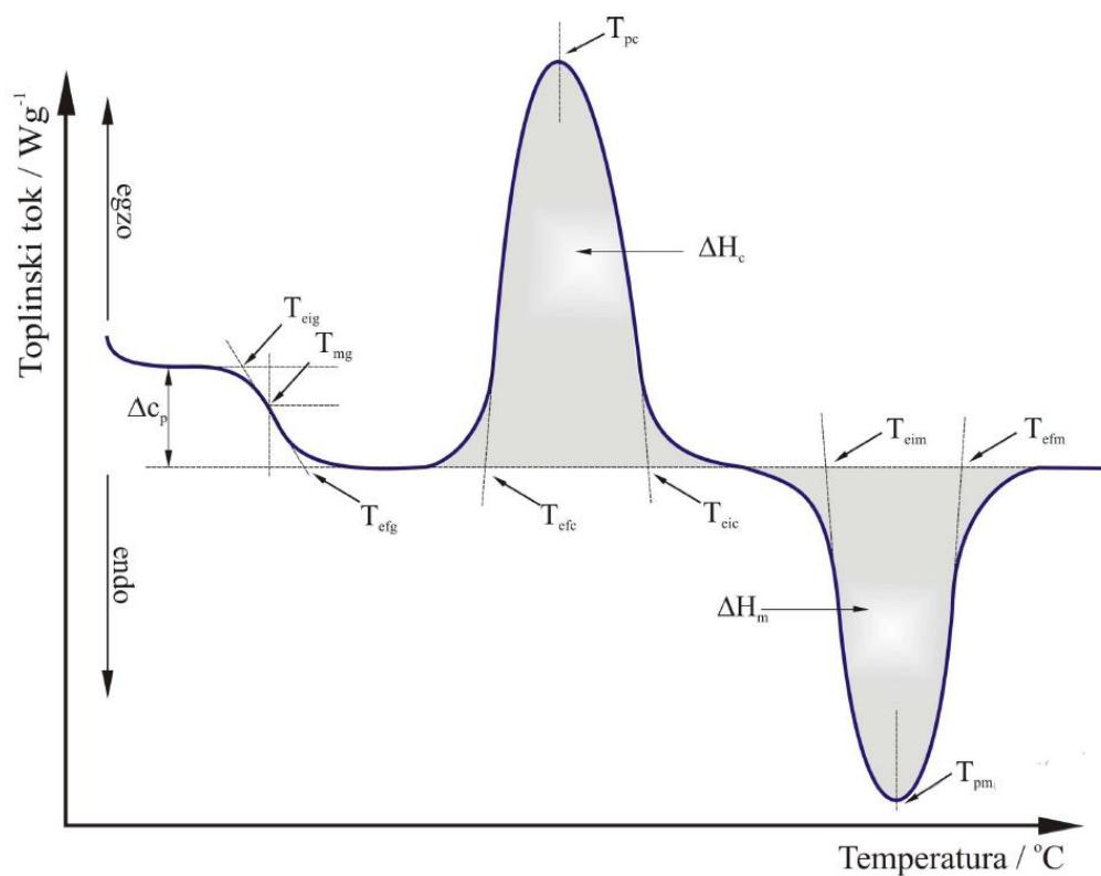
Slika 9. Određivanje značajki krivulje diferencijalne pretražne kalorimetrije<sup>40</sup>
