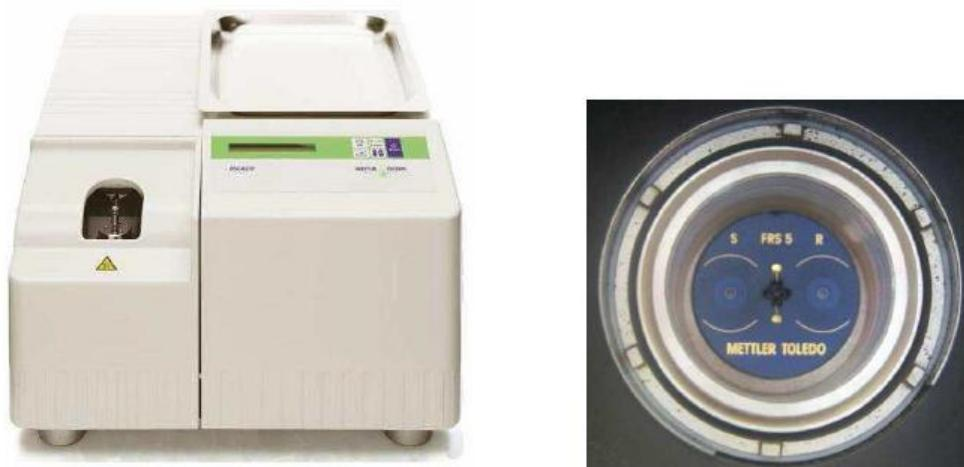
**Slika 14.** Diferencijalni pretražni kalorimetar DSC 823e (Mettler Toledo, Švicarska) i mjerne osjetilo
