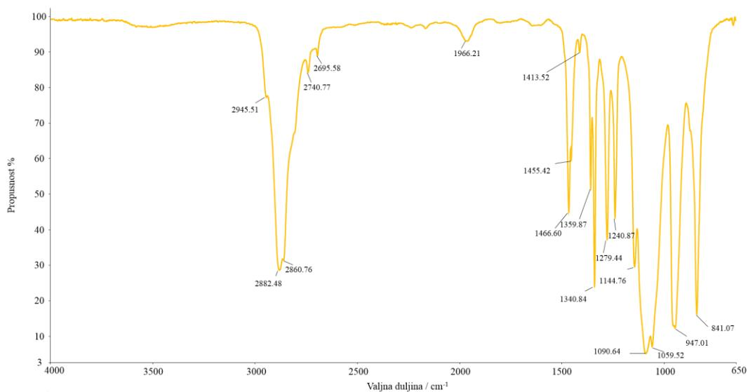
**Slika 27.** FTIR spektrogram mješavine PLA/PEO (0/100)**Tablica 7.** Valni brojevi najznačajnijih vibracijskih vrpcu PEO-a u mješavini\*
