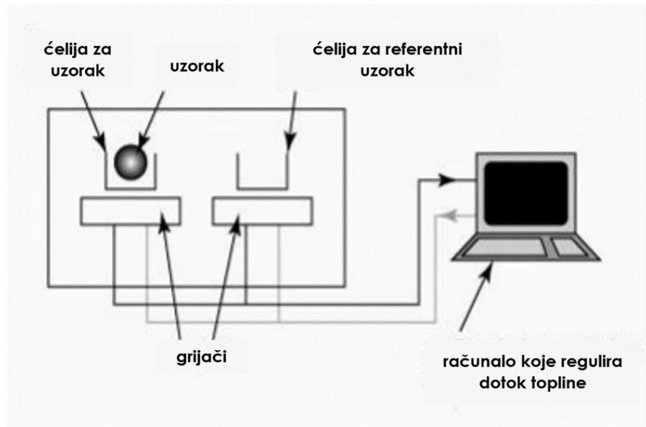
**Slika 6.** Shema uređaja DSC<sup>51</sup>
