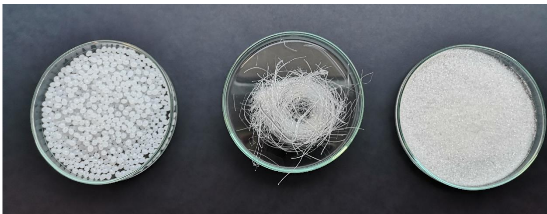
Slika 13. Granule, vlakna, prah PLA-a
