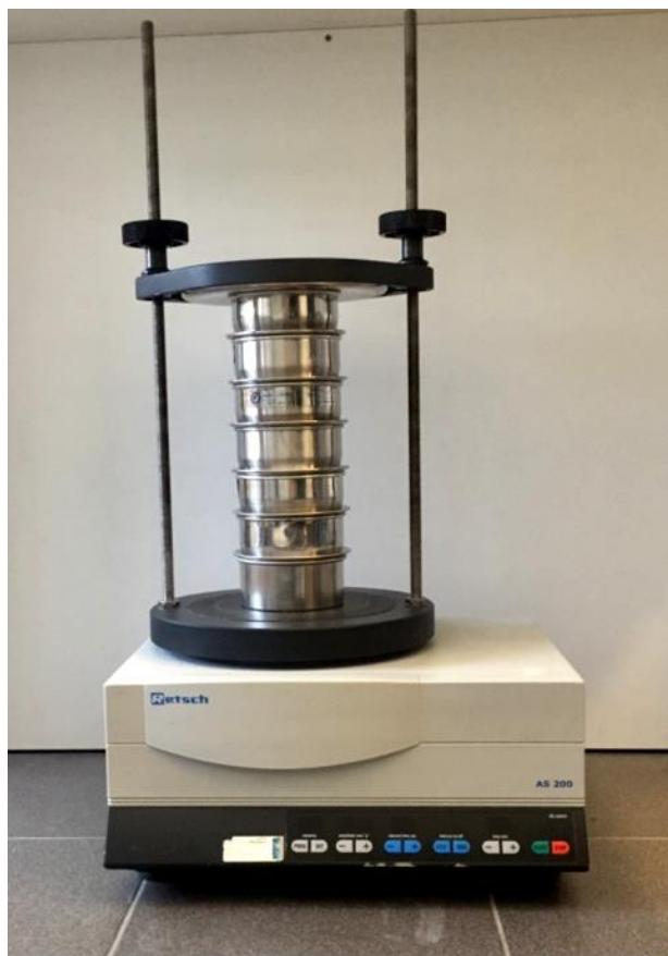
*Slika 25.* Aparatura za provedbu granulometrijske analize prosijavanjem.
