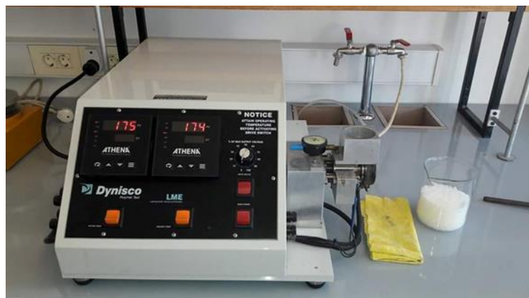
Slika 8. Laboratorijski ekstruder Dynisco LME 230
