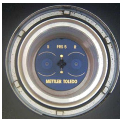
Slika 19. Mjerno osjetilo FRS 5
