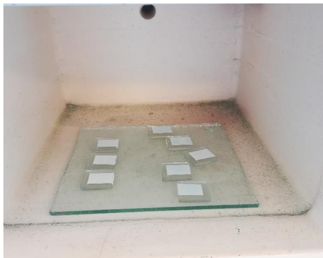
Slika 29. Pečenje oksidnog sloja
