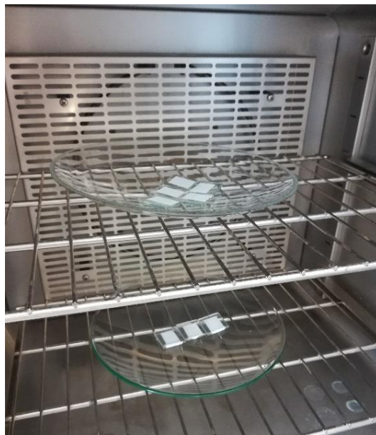
Slika 28. Sušenje oksidnog sloja
