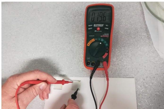
Slika 26. Određivanje vodljive strane stakalaca mjerenjem otpora pomoću multimetra
