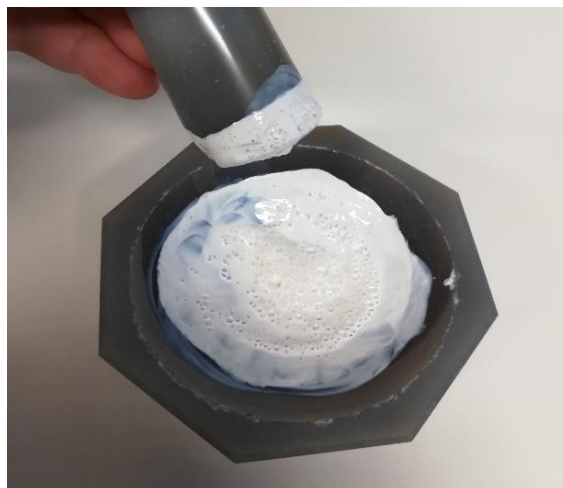
Slika 25. Priprava \text{TiO}_2 paste
