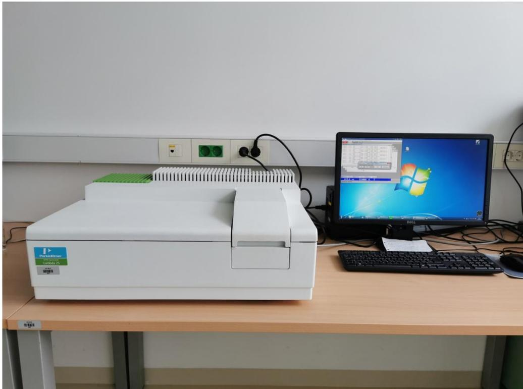
*Slika 2.5. Spektrofotometar Perkin Elmer Lambda 25*
