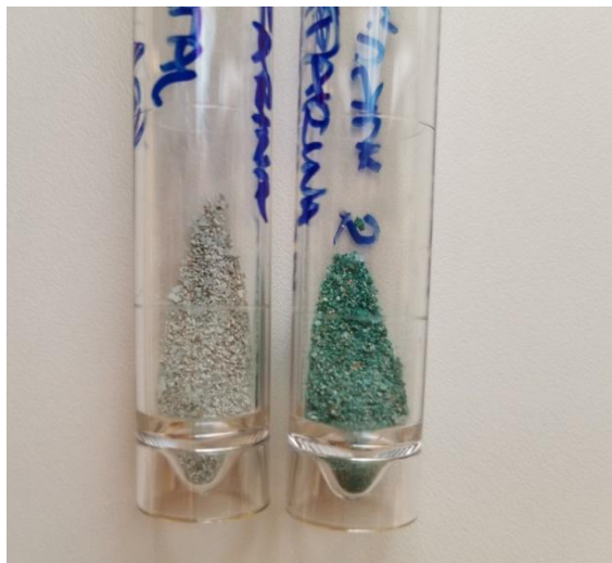
Slika 3.2. Usporedba osušenih uzoraka adsorbensa (ljuski jaja) nakon provedene adsorpcije bakra iz vodene otopine \text{CuCl}_2 \cdot 2\text{H}_2\text{O} najniže i najviše koncentracije
