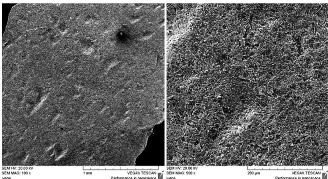
**Slika 25.** Površina CuAlMn legure nakon potenciodinamičkog polarizacijskog mjerena u 0,9% NaCl otopini ( $pH = 7,4$ ) pri  $T = 24\text{ }^{\circ}\text{C}$  uz uvećanje od 100 i 500 puta
