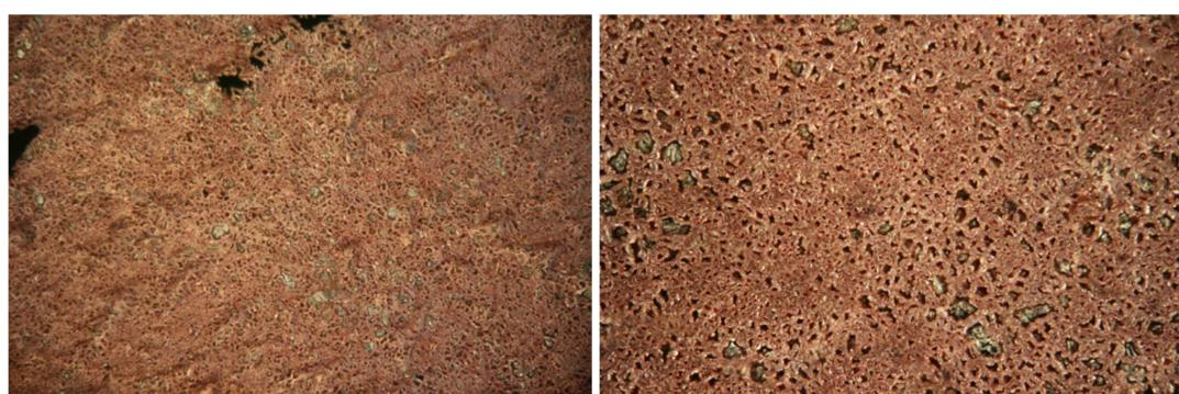
**Slika 23.** Površina CuAlMn legure nakon potenciodinamičkog polarizacijskog mjerena u 0,9% NaCl otopini ( $pH = 7,4$ ) pri  $T = 50\text{ }^{\circ}\text{C}$  uz uvećanje od 100 i 200 puta
