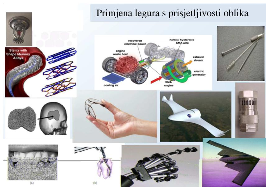
Slika 9. Primjena legura s prisjetljivosti oblika
