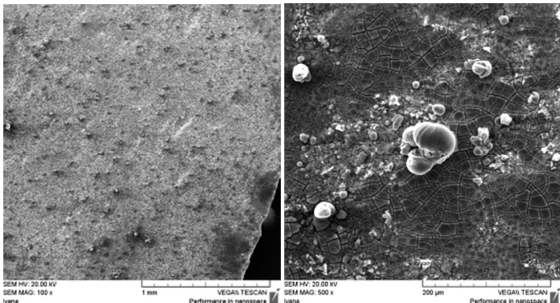
**Slika 24.** Površina CuAlMn legure nakon potenciodinamičkog polarizacijskog mjerena u 0,9% NaCl otopini ( $pH = 7,4$ ) pri  $T = 10\text{ }^{\circ}\text{C}$  uz uvećanje od 100 i 500 puta
