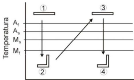
**Slika 5.** Shematski prikaz dvosmjernog efekta prisjetljivosti oblika<sup>9</sup>
