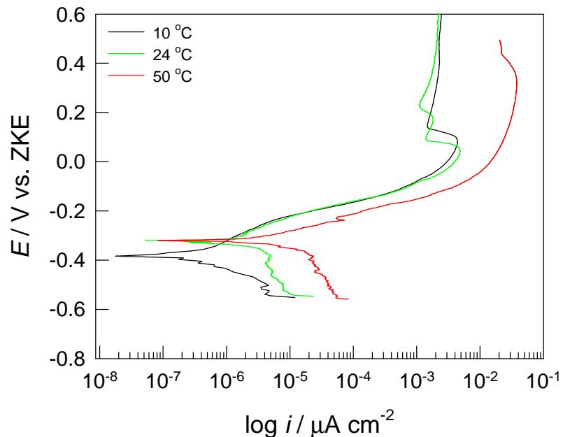
**Slika 20.** Potenciodinamičke polarizacijske krivulje za CuAlMn leguru u 0,9% NaCl otopini ( $\text{pH} = 7,4$ ) pri različitim temperaturama elektrolita
