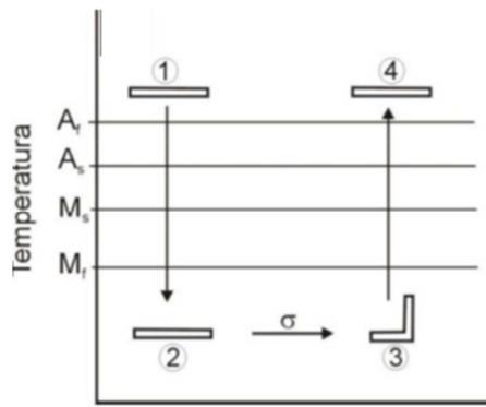
**Slika 4.** Shematski prikaz jednosmjernog efekta prisjetljivosti oblika<sup>9</sup>
