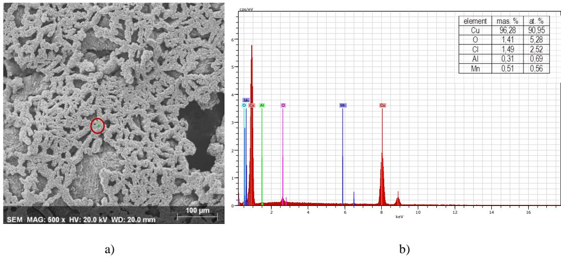
**Slika 29.** a) SEM snimka CuAlMn legure nakon potenciodynamičkog polarizacijskog mjerjenja u 0,9% NaCl otopini ( $pH = 7,4$ ) pri  $T = 50\text{ }^{\circ}\text{C}$  s označenim točkom za EDS analizu; b) EDS analiza površine
