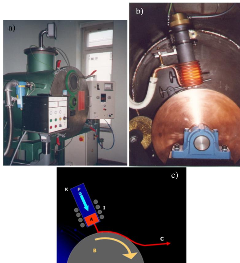
**Slika 8.** a) Uredaj za dobivanje traka metodom brzog hlađenja, b) fotografija grafitnog lonca za taljenje i bakrenog kotača, c) princip rada<sup>20</sup>
