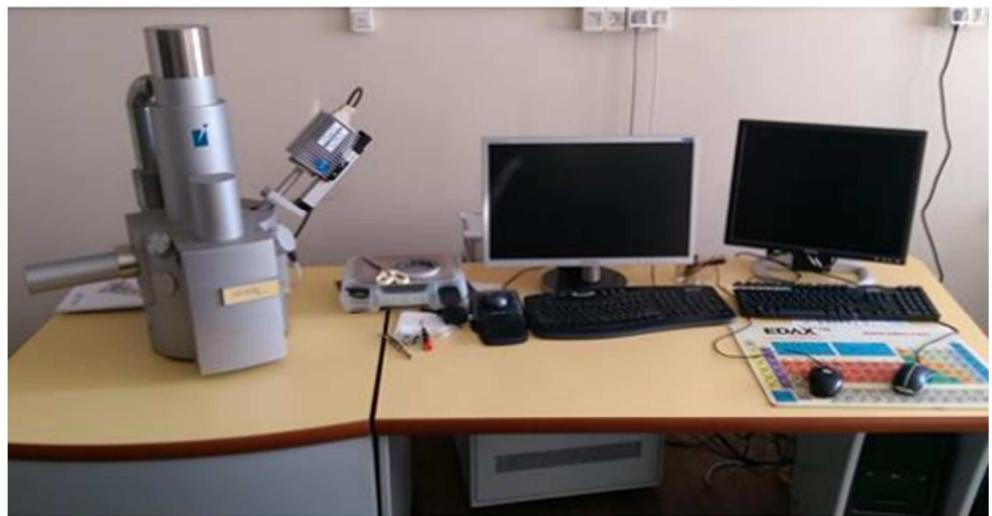
**Slika 14.** Pretražni elektronski mikroskop TESCAN VEGA 5136LS
