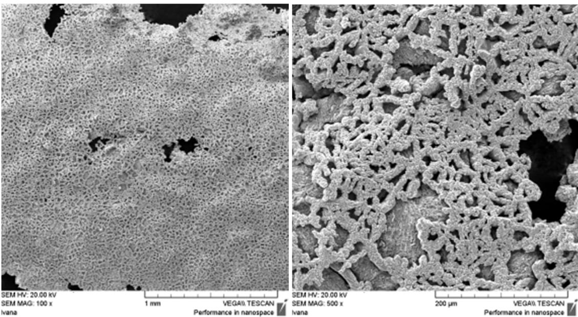
**Slika 26.** Površina CuAlMn legure nakon potenciodinamičkog polarizacijskog mjerena u 0,9% NaCl otopini ( $pH = 7,4$ ) pri  $T = 50^{\circ}\text{C}$  uz uvećanje od 100 i 500 puta
