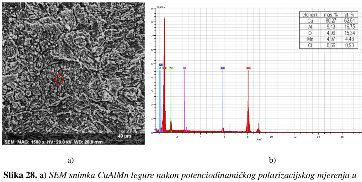
**Slika 28.** a) SEM snimka CuAlMn legure nakon potenciodynamičkog polarizacijskog mjerjenja u 0,9% NaCl otopini ( $pH = 7,4$ ) pri  $T = 24\text{ }^{\circ}\text{C}$  s označenim točkom za EDS analizu; b) EDS analiza površine
