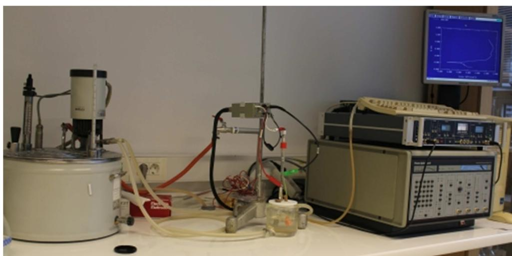
Slika 15. Aparatura za elektrokemijska mjerena
