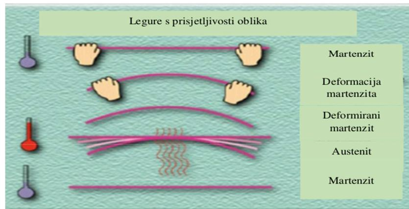
**Slika 1.** Fazne transformacije kod legura s prisjetljivosti oblika<sup>5</sup>
