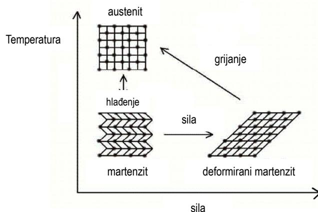
**Slika 2.** Ciklus promjena strukture za SMA legure<sup>5</sup>
