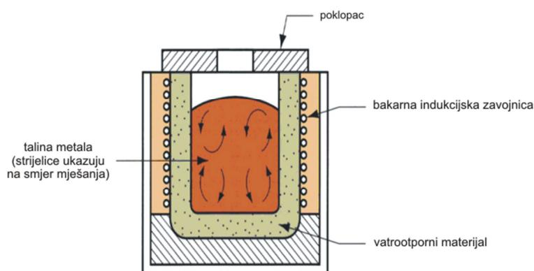
Slika 7. Indukcijsko miješanje unutar peći<sup>16</sup>
