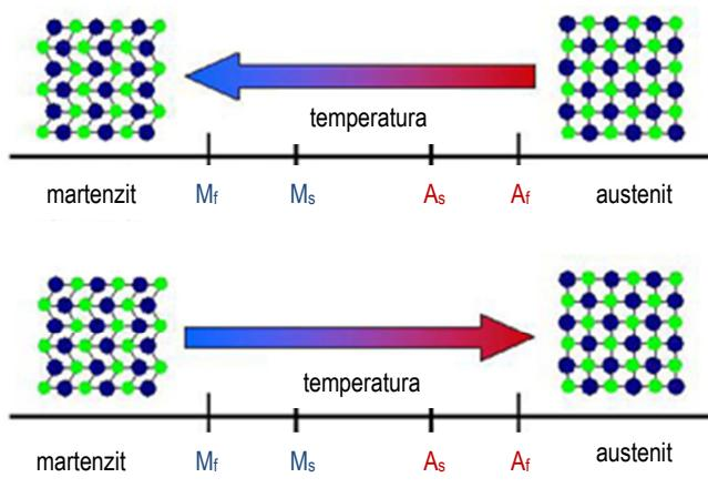
**Slika 3.** Temperaturno inducirane fazne transformacije SMA legura bez djelovanja mehaničke sile<sup>6</sup>
