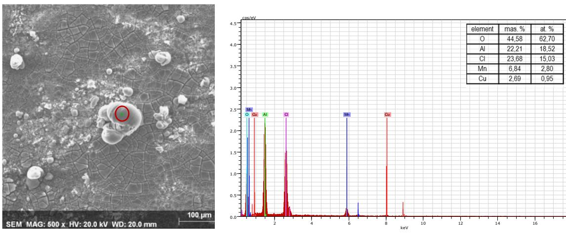
**Slika 27.** a) SEM snimka CuAlMn legure nakon potenciodinamičkog polarizacijskog mjerena u 0,9% NaCl otopini ( $pH = 7,4$ ) pri  $T = 10^{\circ}\text{C}$  s označenim točkom za EDS analizu; b) EDS analiza površine
