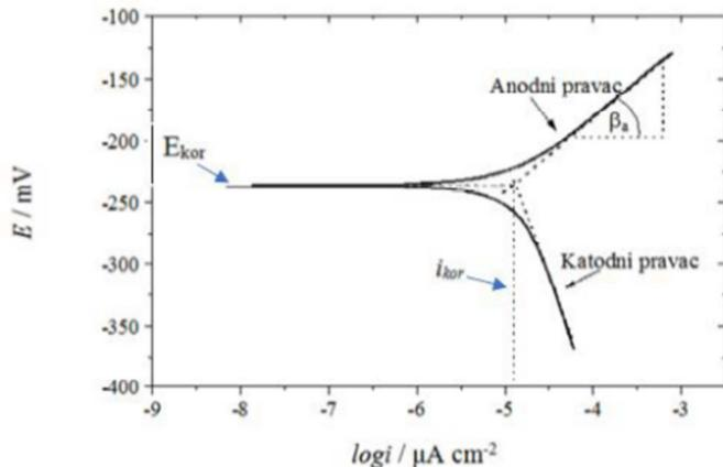
Slika 13. Tafelova metoda određivanja korozijskih parametara iz polarizacijskih mjerena.<sup>22</sup>
