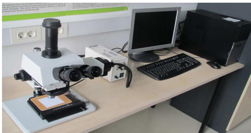
**Slika 17.** Svjetlosni mikroskop MXFMS-BD, Ningbo Sunny Instruments co.
