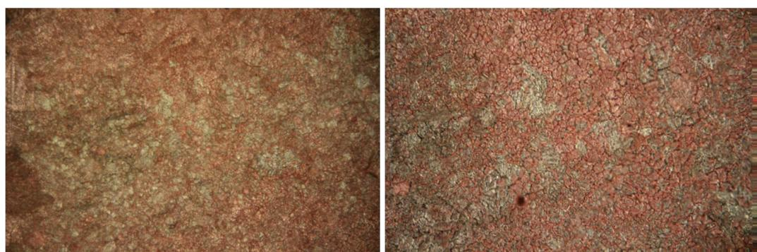
**Slika 22.** Površina CuAlMn legure nakon potenciodinamičkog polarizacijskog mjerena u 0,9% NaCl otopini ( $pH = 7,4$ ) pri  $T = 24\text{ }^{\circ}\text{C}$  uz uvećanje od 100 i 200 puta
