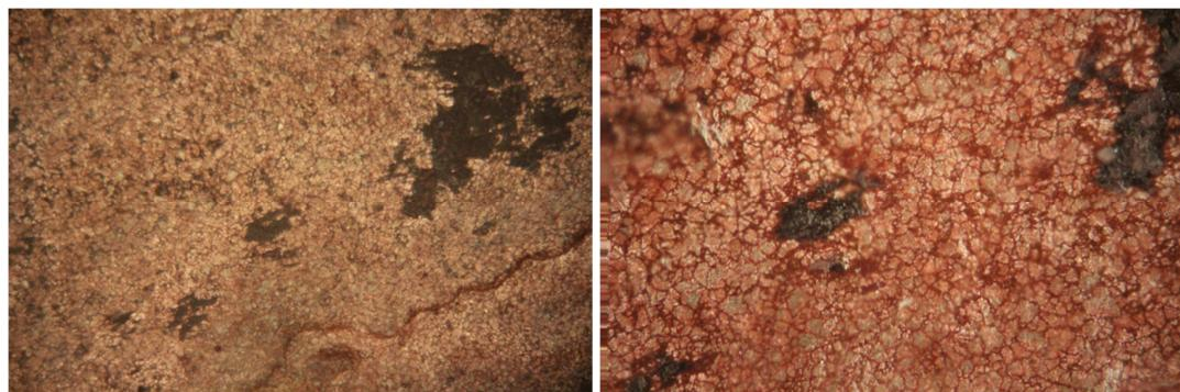
**Slika 21.** Površina CuAlMn legure nakon potenciodinamičkog polarizacijskog mjerena u 0,9% NaCl otopini ( $pH = 7,4$ ) pri  $T = 10\text{ }^{\circ}\text{C}$  uz uvećanje od 100 i 200 puta
