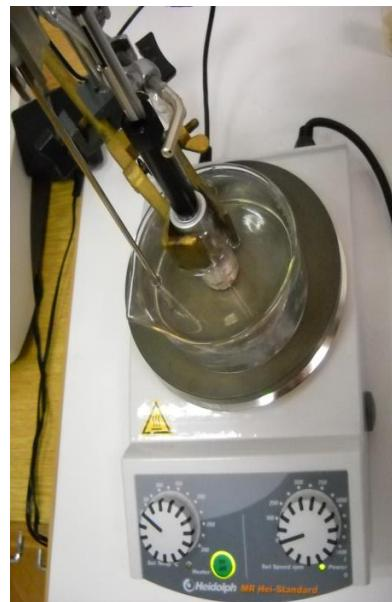
Prije upotrebe, u skladu s uputama proizvođača, sivo vlakno aktivirano kondicioniranjem 60 min na  $270^{\circ}\text{C}$  i to postavljanjem SPME igle u injektor plinskog kromatografa. Nakon kondicioniranja, vlakna su odmah korištena za ekstrakciju vršnih para uzoraka (18).
