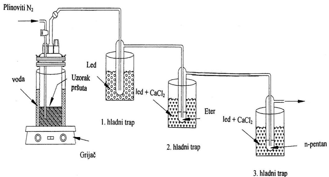
**Slika 6.** Aparatura za destilaciju sa dušikom i trapovima (11)
