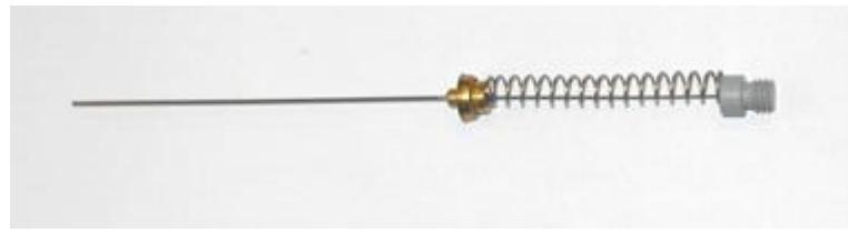
**Slika 11.** Vlakna s ovojnicama DVB/CAR/PDMS (sivo vlakno)
