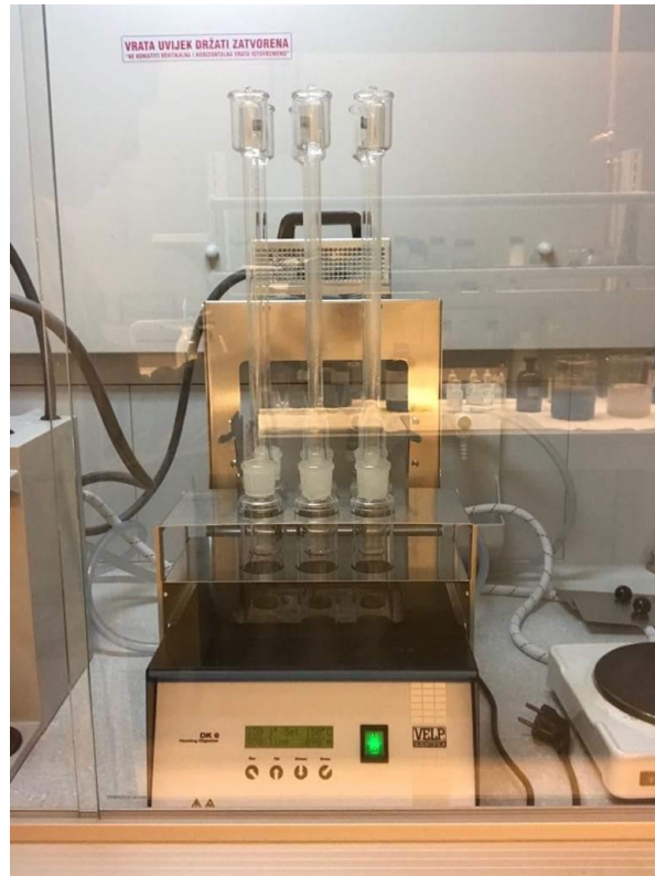
Slika 2.4. Kuhanje smjese u digestoru uz refleks
