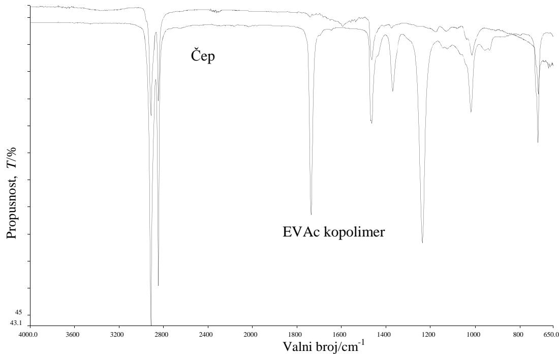
Slika 25. Uzorak 25.b (zatvarač), usporedba s bazom podataka podudarnost 88,0 % sa spektrom EVAc-a
