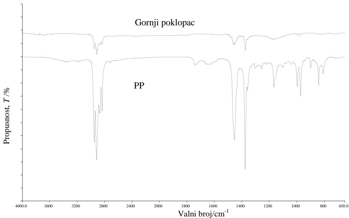
Slika 19. Uzorak 18.b (gornji poklopac), usporedba s bazom podataka podudarnost 90,0 % sa spektrom PP
