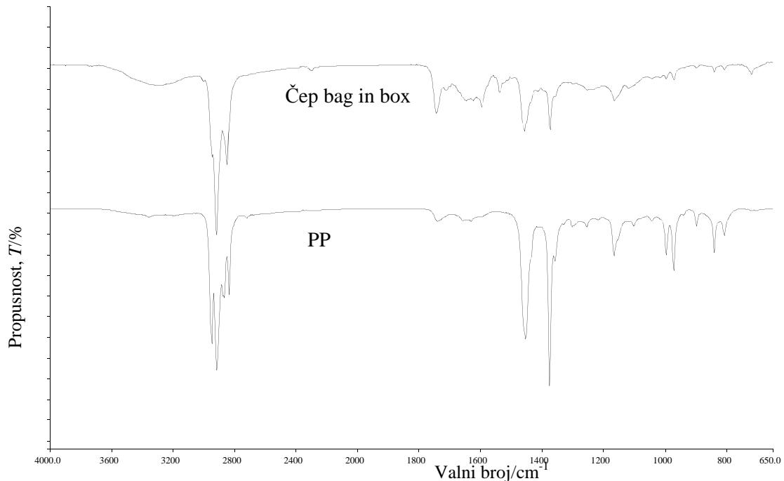
Slika 29. Uzorak 26.b ( crveni dio zatvarača) , usporedba s bazom podataka, podudarnost 60,3 % sa spektrom PP-a
