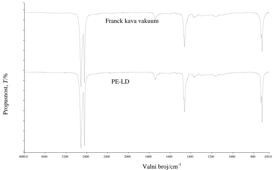
Slika 15. Uzorak 15a (folija-unutrašnji dio), usporedba s bazom podataka, podudarnost 96,0 % sa spektrom PE-LD-a
