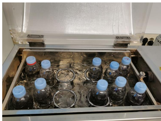
Slika 2.7. Reaktori u vodenoj kupelji s trešnjom
