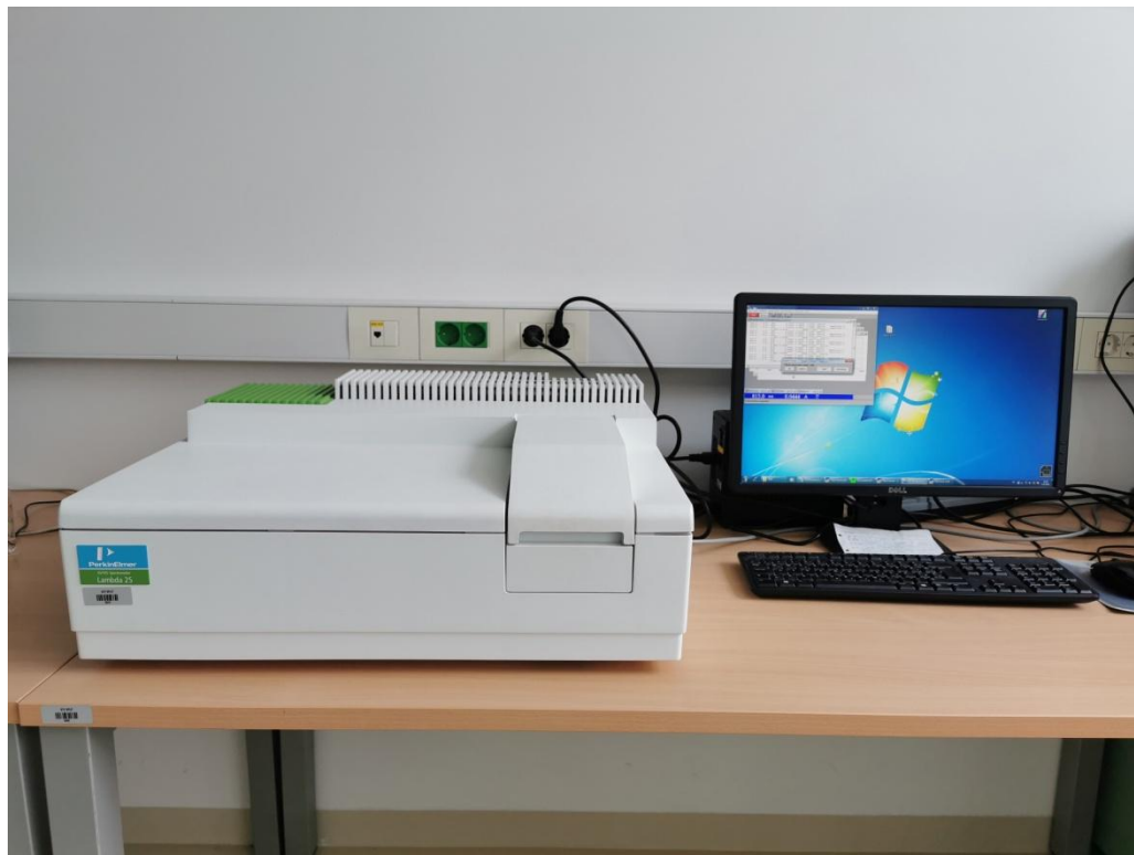
Slika 2.5. Spektrofotometer Perkin Elmer Lambda 25
