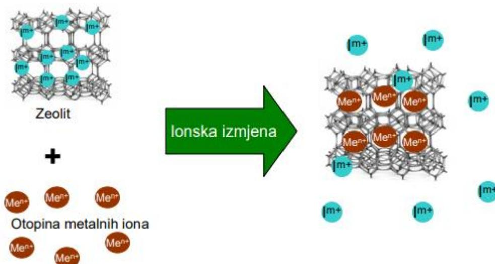
*Slika 1.4. Prikaz procesa ionske izmjene metalnog iona iz otopine s izmjenjivim kationima iz strukture zeolita<sup>7</sup>*
