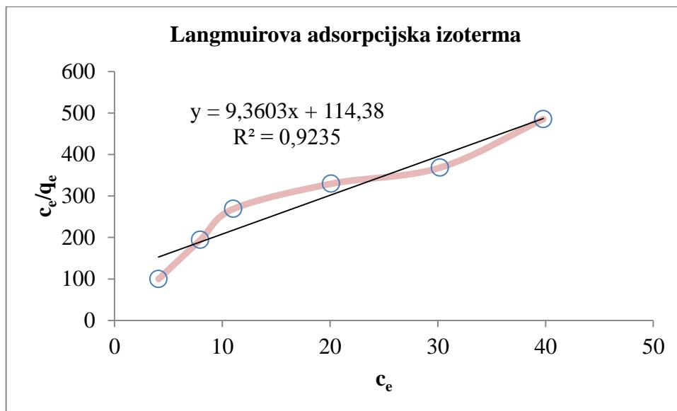
*Slika 3.3. Slaganje Langmuirove adsorpcijske izoterme s eksperimentalnim podatcima za adsorpciju kobaltovih iona na ljuskama jaja*
