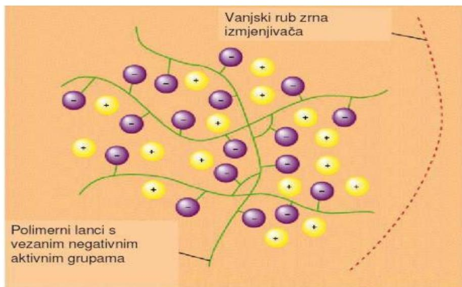
Slika 1.3. Shematski prikaz strukture ionskog izmjenjivača<sup>4</sup>
