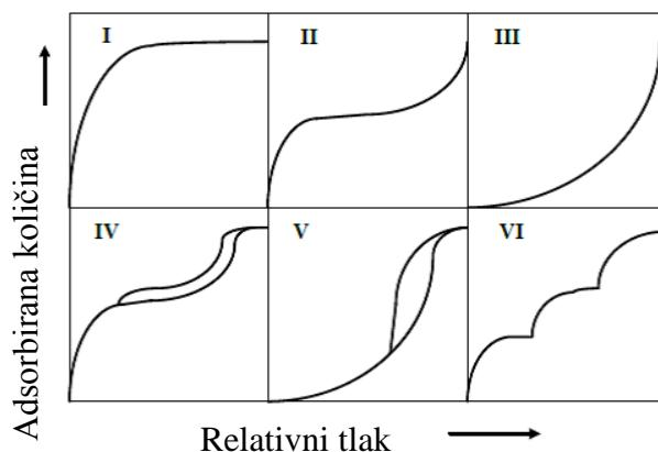
**Slika 1.8. Tipovi adsorpcijskih izotermi<sup>12</sup>**
