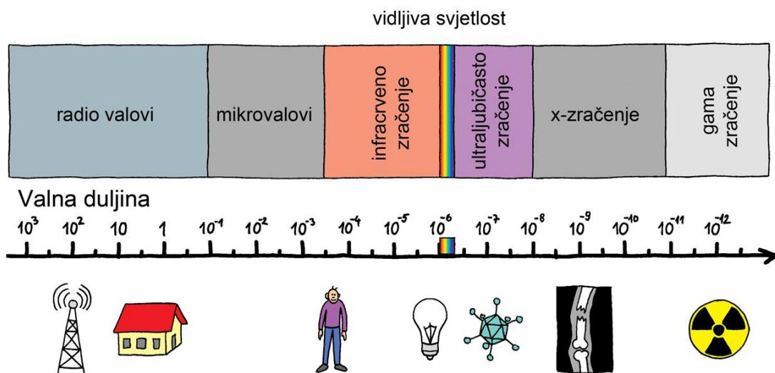
Slika 1.11. Elektromagnetski spektar<sup>23</sup>
