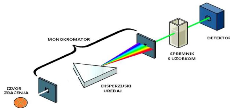
*Slika 1.12. Shematski prikaz spektrofotometra<sup>26</sup>*
