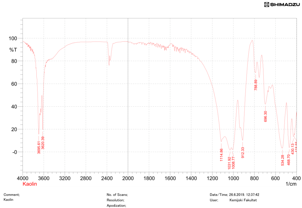
Slika 3.1. FTIR spektar kaolina prije sorpcije
