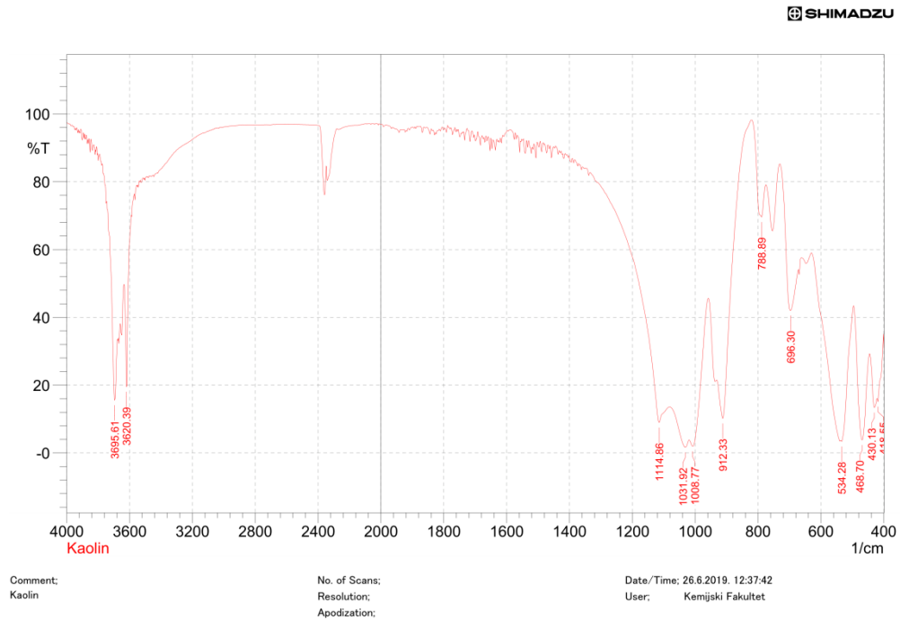
Slika 3.1. FTIR spektar kaolina prije sorpcije
