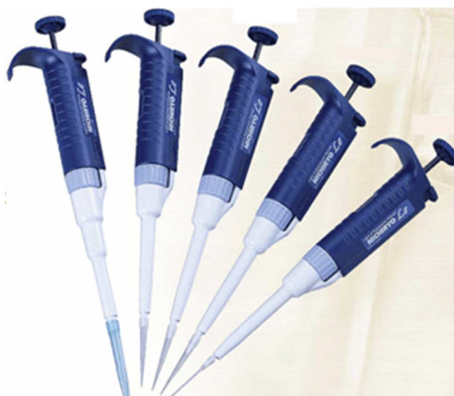
Slika 3-6 Mikropipete Nichiryo za dodavanje volumena od 0,5 do 1000 \mu\text{L}
