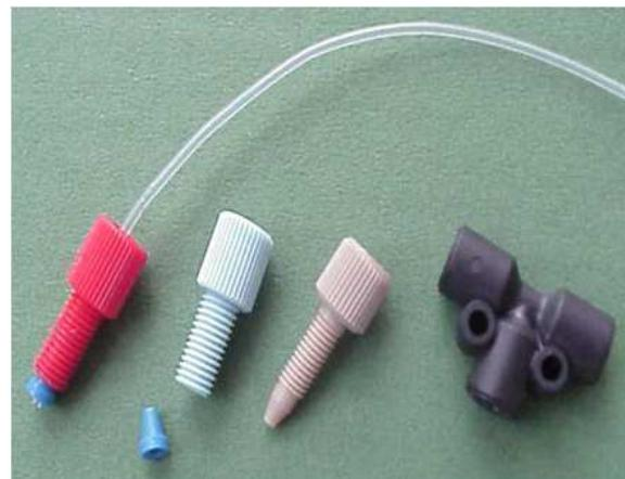
Slika 2-20 Komponente prijenosnog sustava: cijevi, vijci, stezne maticе
