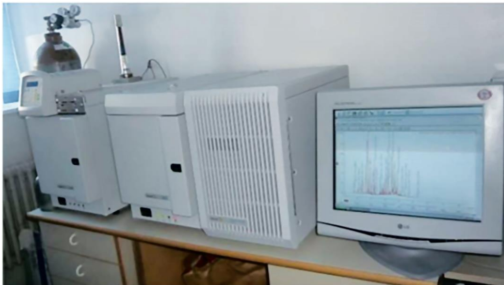
Slika 3.5. Vezni sustav plinski kromatograf - maseni spektrometar (GC/MS)
