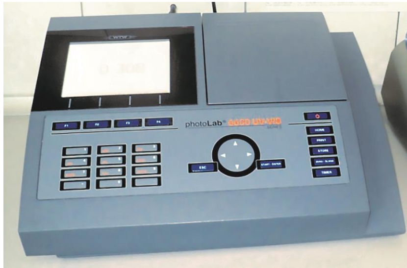
Slika 3.7. Spektrofotometar photoLab 6600 UV-VIS
