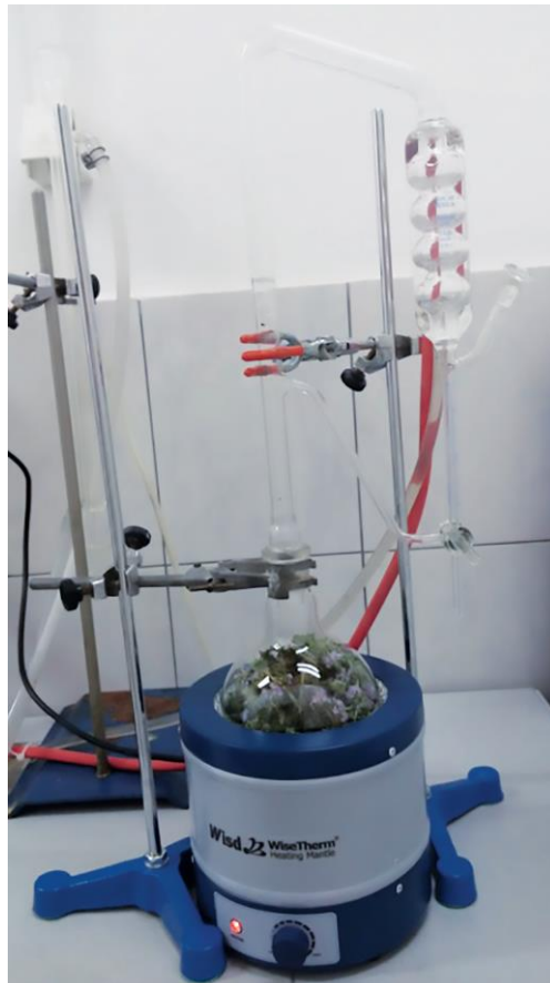
Slika 3.2. Aparatura po Clevengeru
