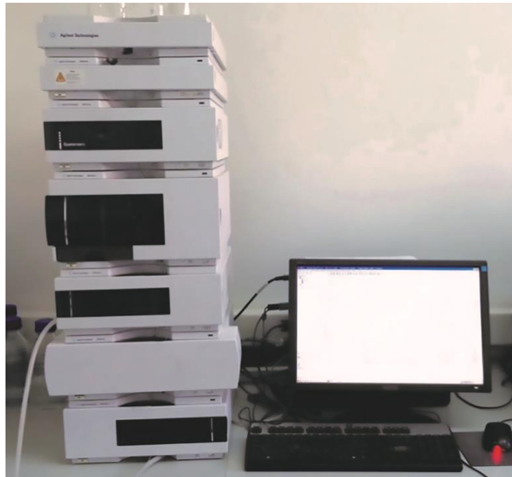
Slika 3.6. Uređaj HPLC/DAD Agilent 1200
