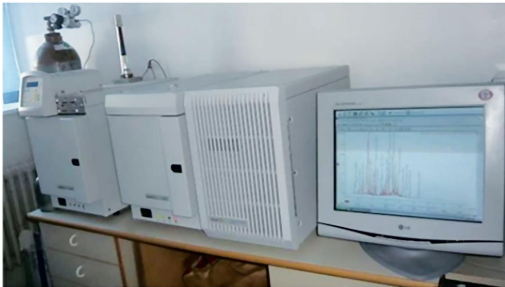
Slika 3.5. Vezni sustav plinski kromatograf - maseni spektrometar (GC/MS)
