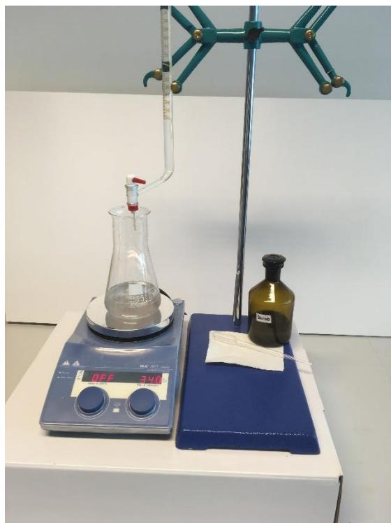
Slika 3.8. Određivanje askorbinske kiseline - nakon završne točke titracije
