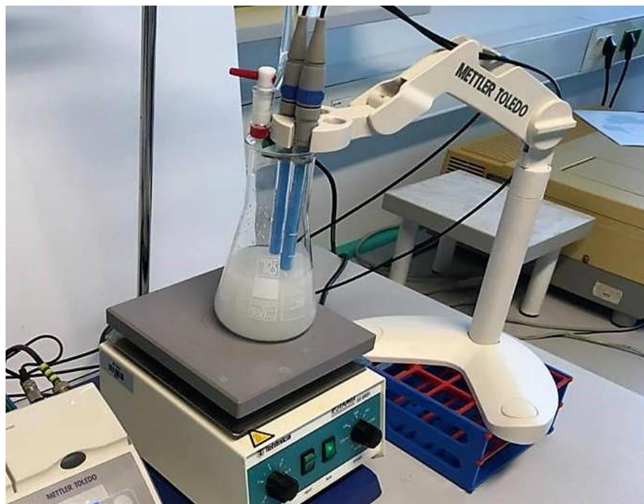
Slika 3.6. Prikaz aparature za potenciometrijsko praćenje redoks-titracije, određivanja
