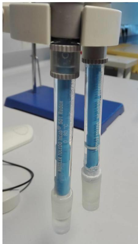
Slika 2.4. Redoks elektroda i referentna Ag/AgCl elektroda
