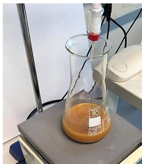
Slika 2.3. Određivanje bakrovih(II) iona - prije završne točke titracije
