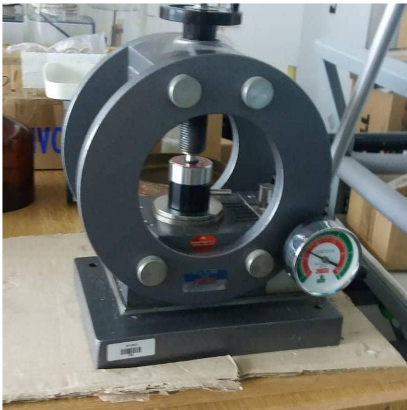
Slika 7 - Preša za pripravu membrana
