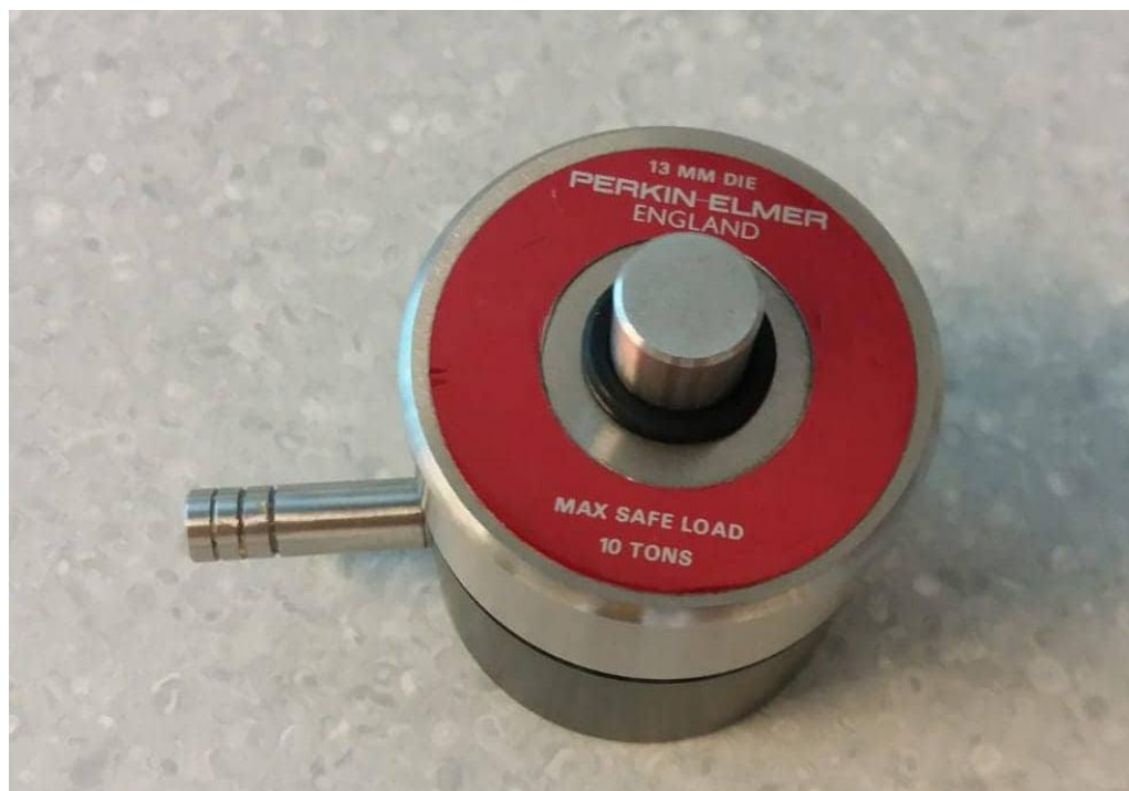
Slika 8 - Kalup za prešanje membrana
