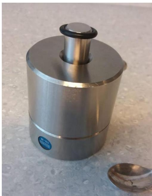
**Slika 2.2.2.1.** Kalup za pripremu membrane
