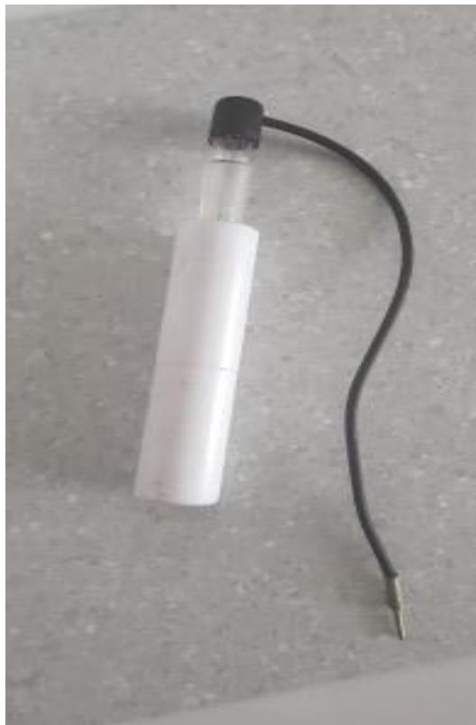
**Slika 2.3.** Tijelo za elektrodu s unutrašnjom elektrodom
