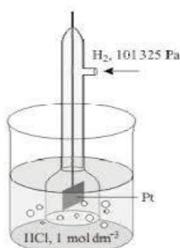
**Slika 3.** Standardna vodikova elektroda<sup>6</sup>
