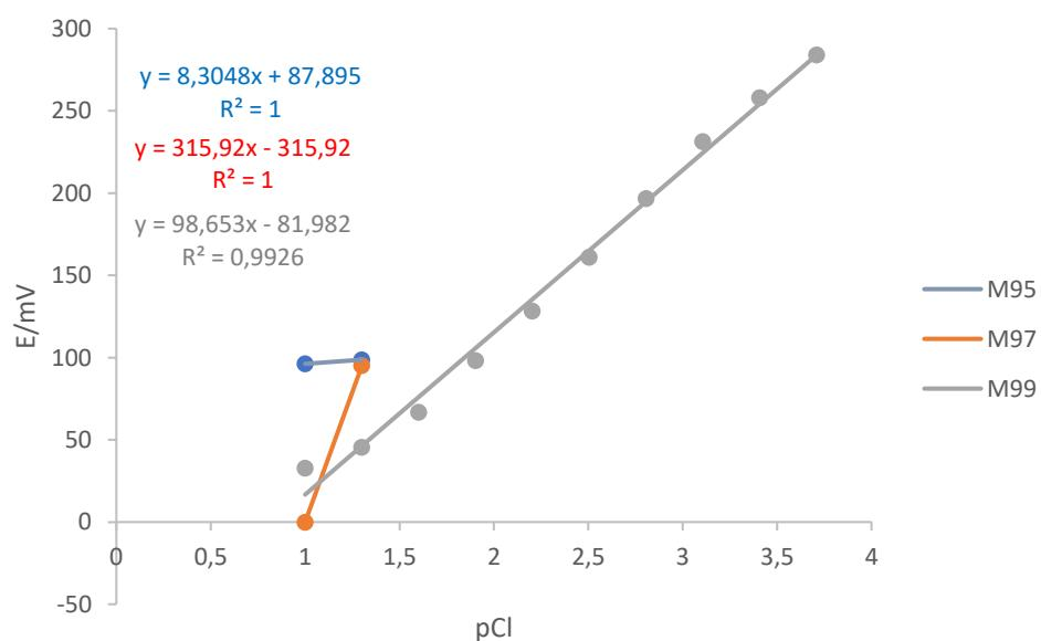
**Slika 18.** Prikaz testiranja odziva elektrode na  $\text{Cl}^-$
