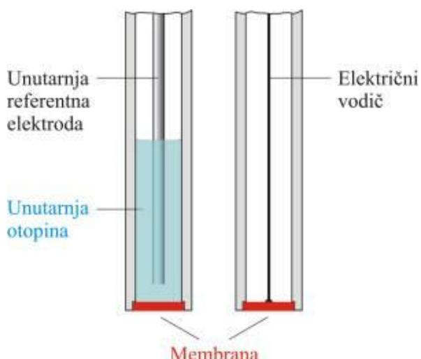
**Slika 8.** Izgled elektrode s kristalnom membranom<sup>6</sup>
