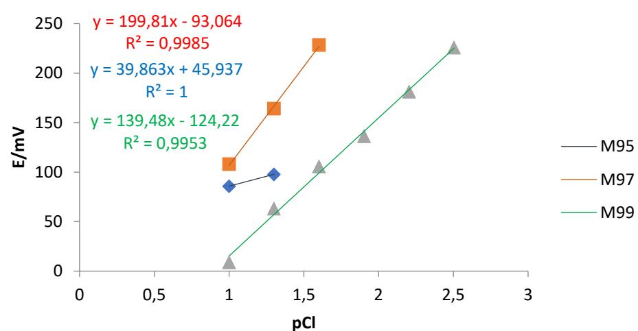
**Slika 15.** Prikaz testiranja odziva elektrode na  $\text{Cl}^-$
