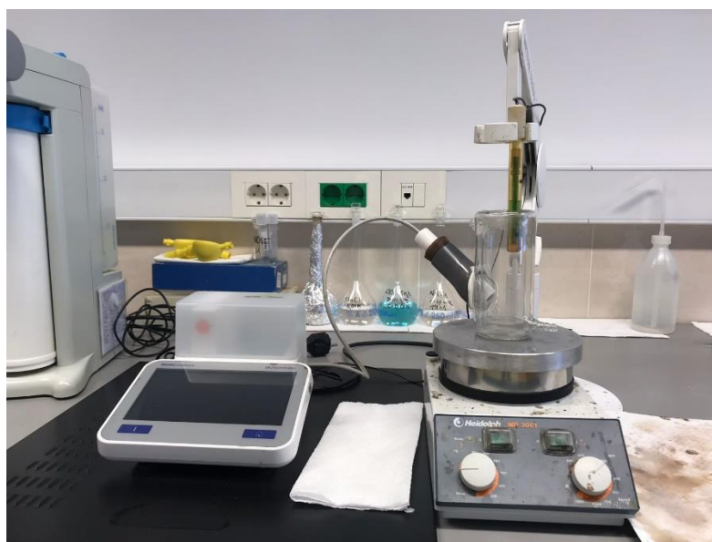
Slika 11. Prikaz sustava za potenciometrijsko mjerenje
