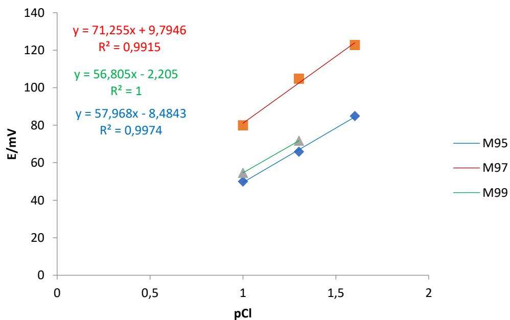
**Slika 16.** Prikaz testiranja odziva elektrode na  $\text{Cl}^-$
