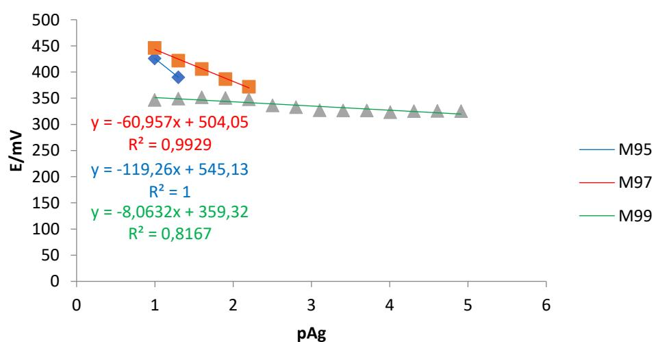
**Slika 12.** Prikaz testiranja odziva elektrode na  $\text{Ag}^+$
