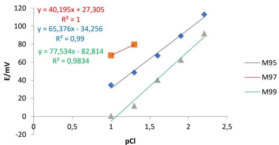
**Slika 17.** Prikaz testiranja odziva elektrode na  $\text{Cl}^-$
