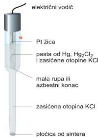
Slika 5. Prikaz kalomelove elektrode 3
