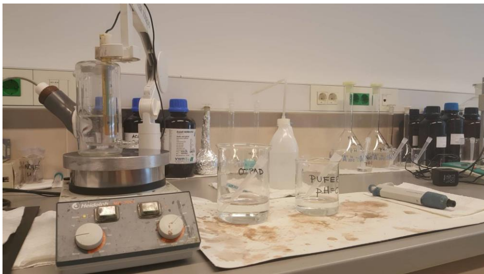
Slika 7. Aparatura za potenciometrijsko mjerenje
