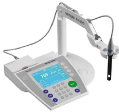
Slika 15. Milivoltmetar Mettler Toledo SevenMulti sa staklenom elektrodom.
