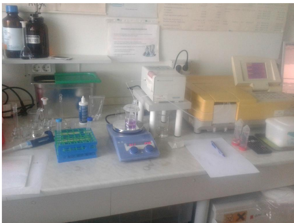
Slika 14. Sustav za provođenje kinetičkih spektrofotometrijskih mjerenja.
