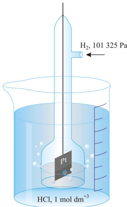
**Slika 2.** Standardna vodikova elektroda<sup>3</sup>
