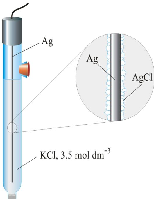
**Slika 4.** Elektroda  $\text{Ag}/\text{AgCl}$
