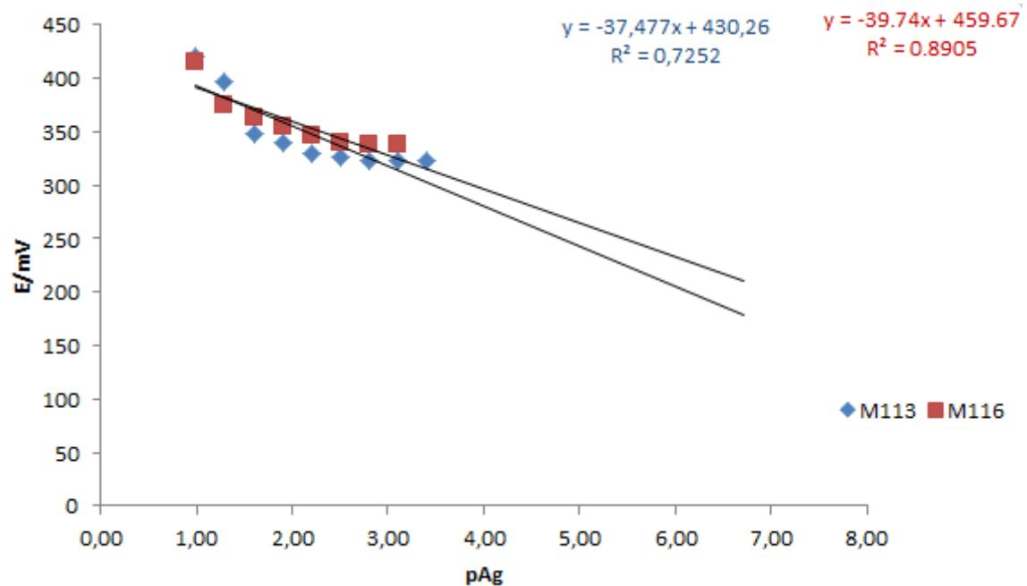
**Slika 9.** Prikaz testiranja odziva elektrode na srebrove katione
