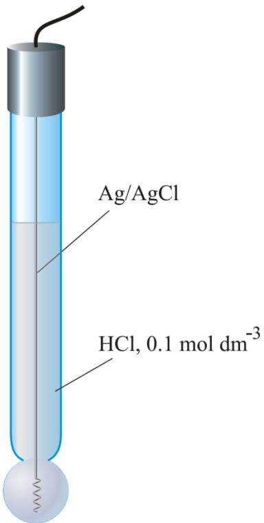
**Slika 5.** Shematski prikaz elektrode s nekristalnom membranom – staklena elektroda za mjerjenje pH<sup>2</sup>
