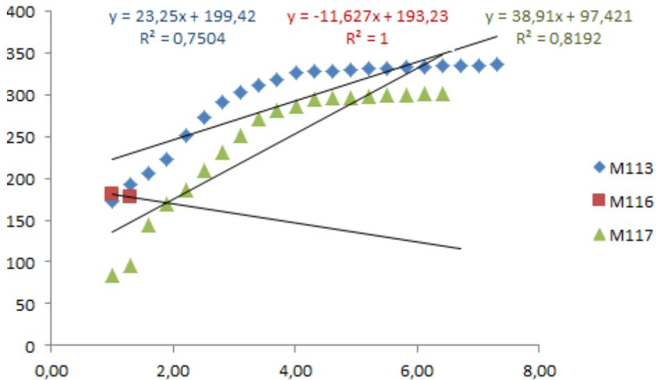
**Slika 14.** Prikaz testiranja odziva elektrode na kloridne ione
