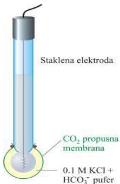
**Slika 6.** Shematski prikaz elektrode za plinove<sup>3</sup>
