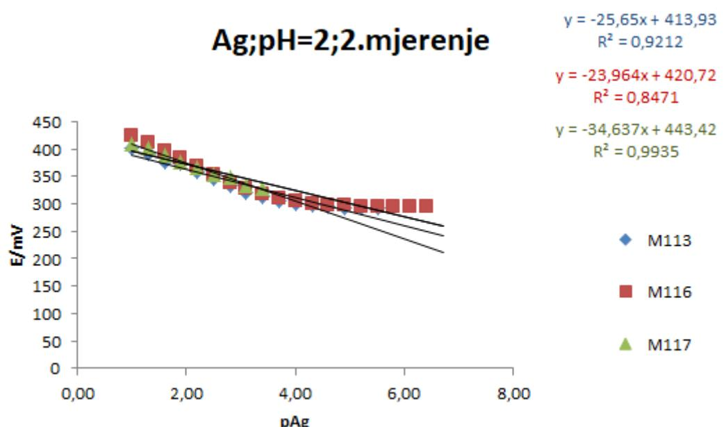
**Slika 13.** Prikaz testiranja odziva elektrode na srebrove katione
