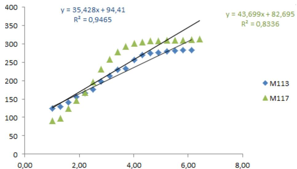
**Slika 17.** Prikaz testiranja odziva elektrode na kloridne ione
