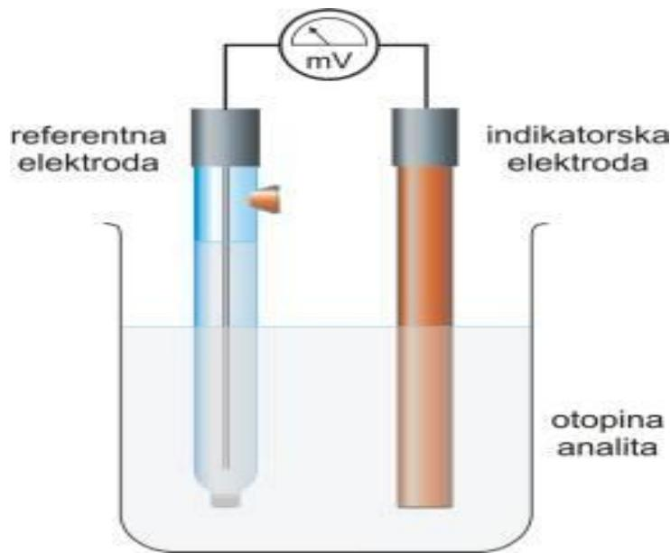
**Slika 1.** Prikaz referentne elektrode<sup>2</sup>
