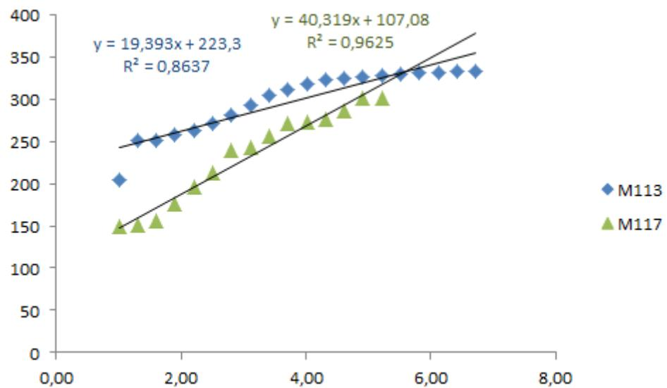
Slika 15. Prikaz testiranja odziva elektrode na kloridne ione
