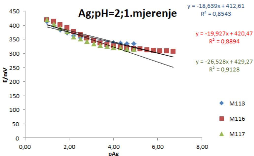
**Slika 12.** Prikaz testiranja odziva elektrode na srebrove katione
