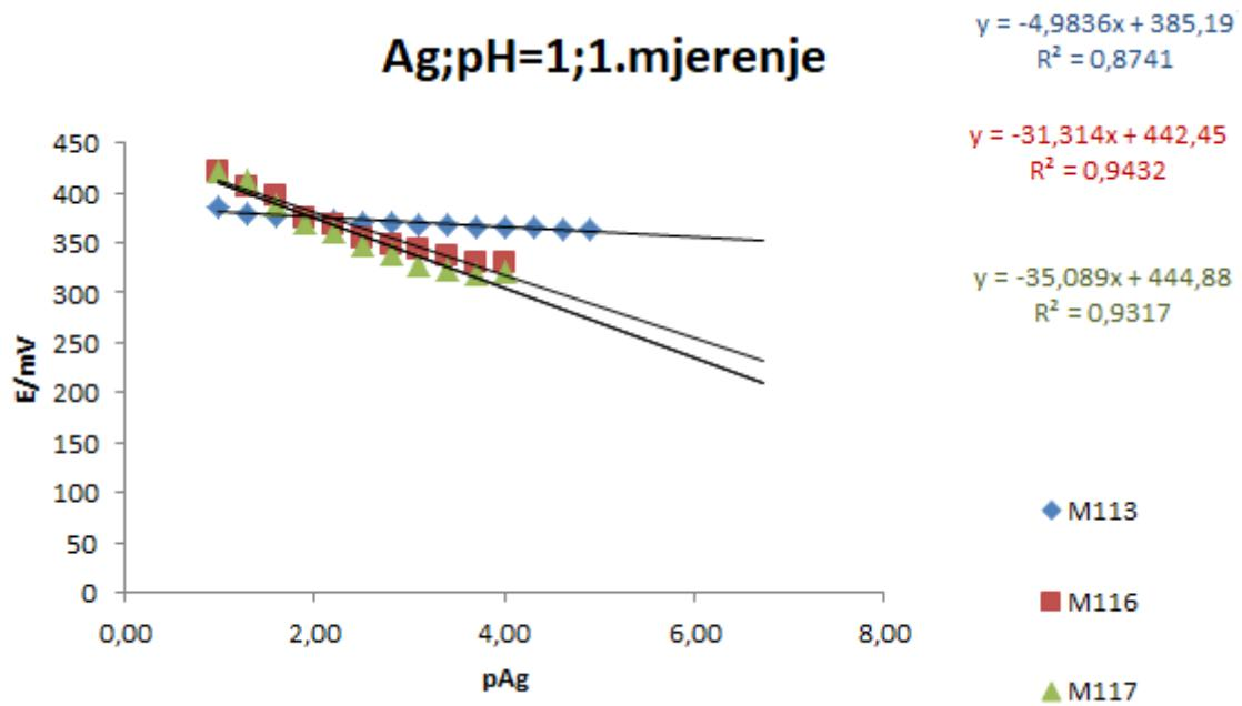
**Slika 10.** Prikaz testiranja odziva elektrode na srebrove katione
