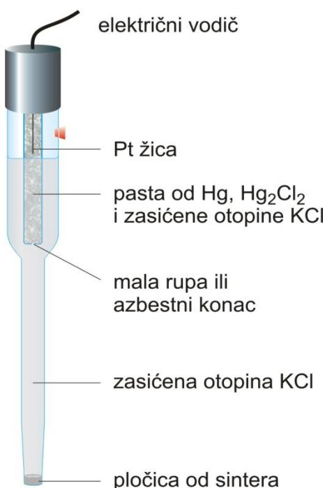
**Slika 3.** Shematski prikaz zasićene kalomelove elektrode<sup>3</sup>
