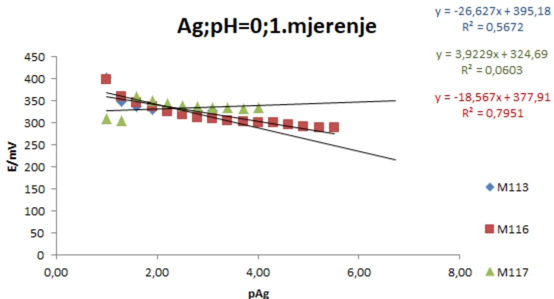
**Slika 8.** Prikaz testiranja odziva elektrode na srebrove katione
