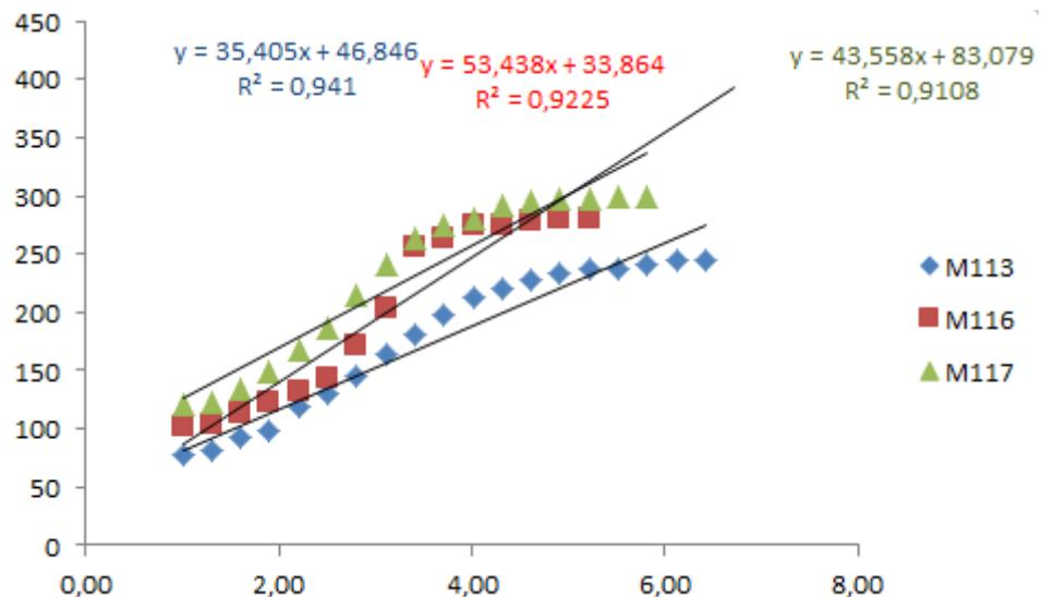
**Slika 18.** Prikaz testiranja odziva elektrode na kloridne ione
