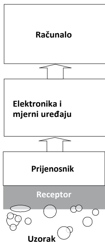
Slika 2: Shema kemijskog senzora
