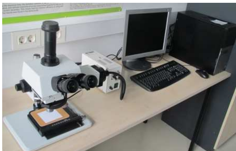
Slika 15. Optički mikroskop MXFMS-BD, Ningbo Sunny Instruments co.
