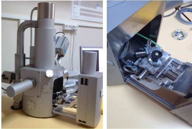
Slika 16. Pretražni elektronski mikroskop Tescan Vega TS5136LS
