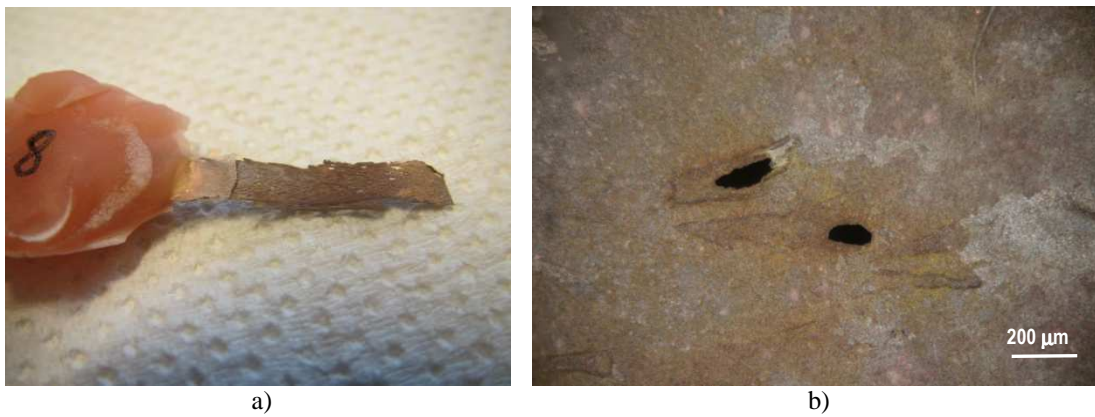
Slika 28. a) makro snimka i b) mikroskopska snimka površine CuAlMnTi legure nakon potenciodinamičkog polarizacijskog mjerenja u 0,9 % NaCl otopini ( pH = 3,4 ) pri T = 37\text{ }^{\circ}\text{C}
