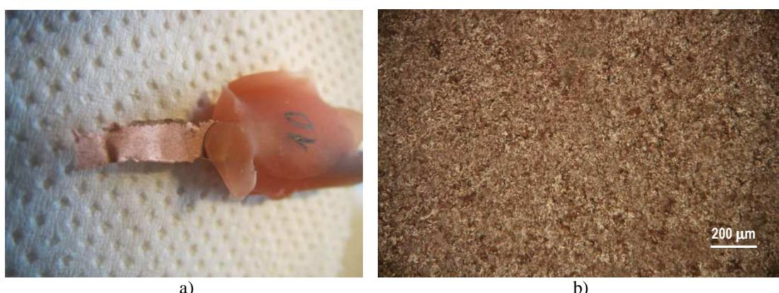
Slika 24. a) makro snimka i b) mikroskopska snimka površine CuAlMnTi legure nakon potenciodinamičkog polarizacijskog mjerena u 0,9 % NaCl otopini ( $pH = 7,4$ ) pri  $T = 24^{\circ}C$
