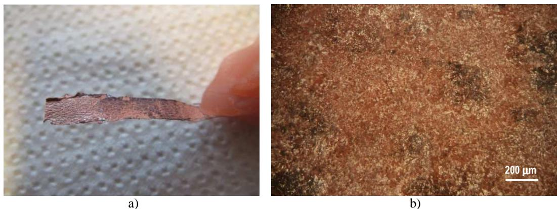
Slika 23. a) makro snimka i b) mikroskopska snimka površine CuAlMnTi legure nakon potenciodinamičkog polarizacijskog mjerena u 0,9 % NaCl otopini ( $pH = 7,4$ ) pri  $T = 10^{\circ}C$
