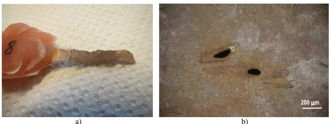
**Slika 28.** a) makro snimka i b) mikroskopska snimka površine CuAlMnTi legure nakon potenciodinamičkog polarizacijskog mjerjenja u 0,9 % NaCl otopini ( $pH = 3,4$ ) pri  $T = 37^{\circ}C$
