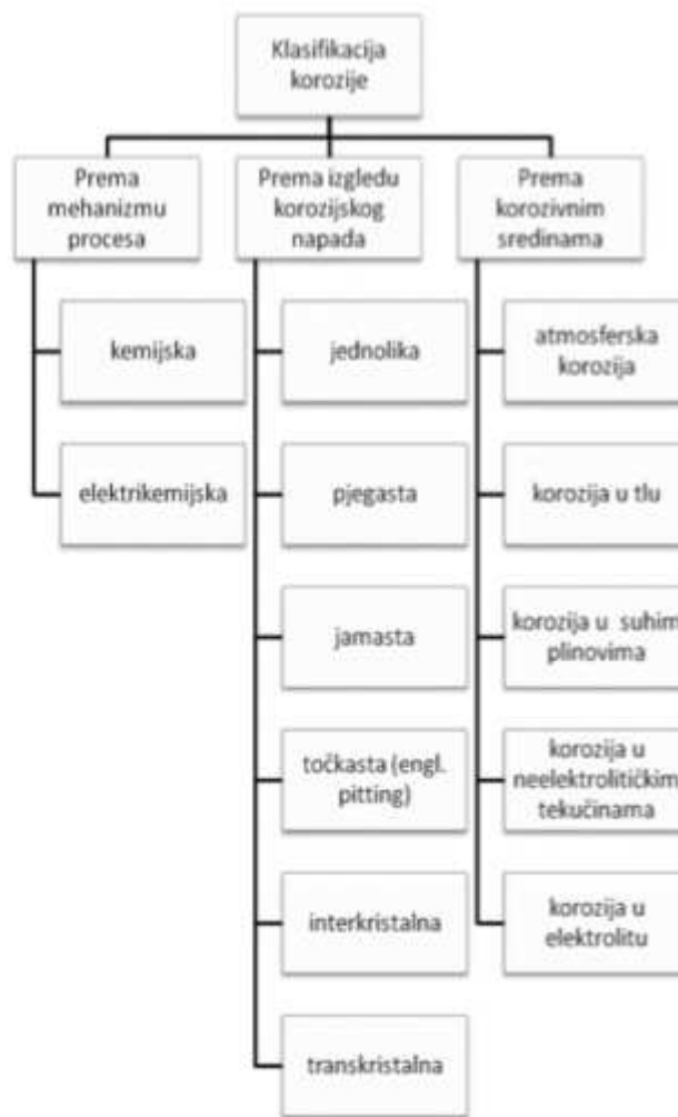
Slika 8. Klasifikacija korozijskih procesa 1
