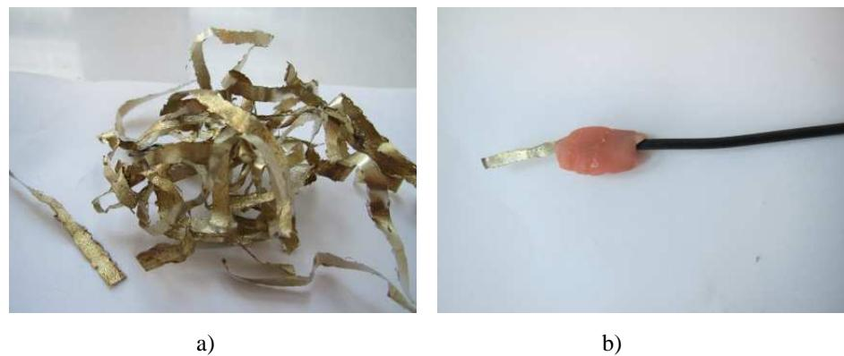
**Slika 12.** a) Traka legure dobivena postupkom brzog hlađenja; b) pripremljena elektroda za elektrokemijska mjerena
