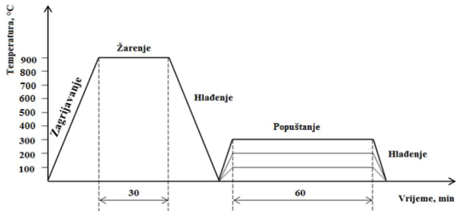
**Slika 14.** Shematski prikaz provedenog postupka toplinske obrade CuAlMn legure<sup>(33)</sup>
