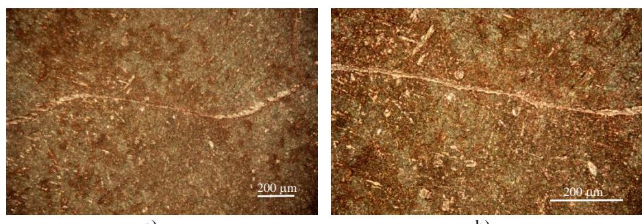
**Slika 29.** Mikroskopska snimka površine CuAlMn legure (kaljeno stanje) nakon potenciodinamičkog polarizacijskog mjerena u 0,1 % NaCl otopini uz uvećanje a) 100 puta i b) 200 puta
