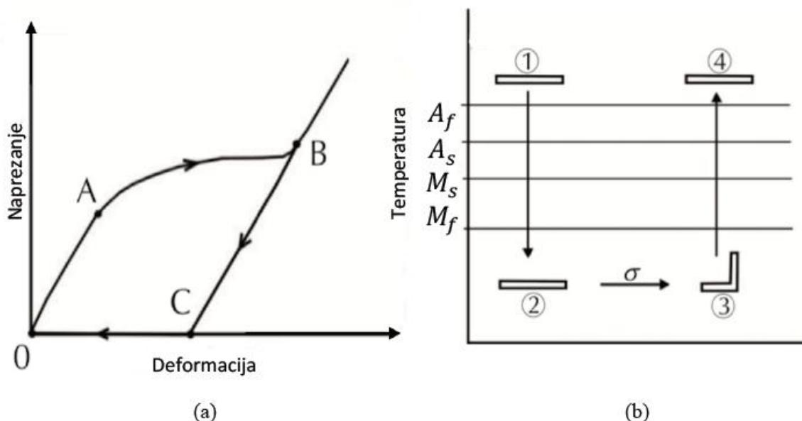
**Slika 5.** Dijagram naprezanja- deformacija za leguru s prisjetljivosti oblika a) i shematski prikaz jednosmjernog efekta prisjetljivosti oblika b)<sup>(3)</sup>
