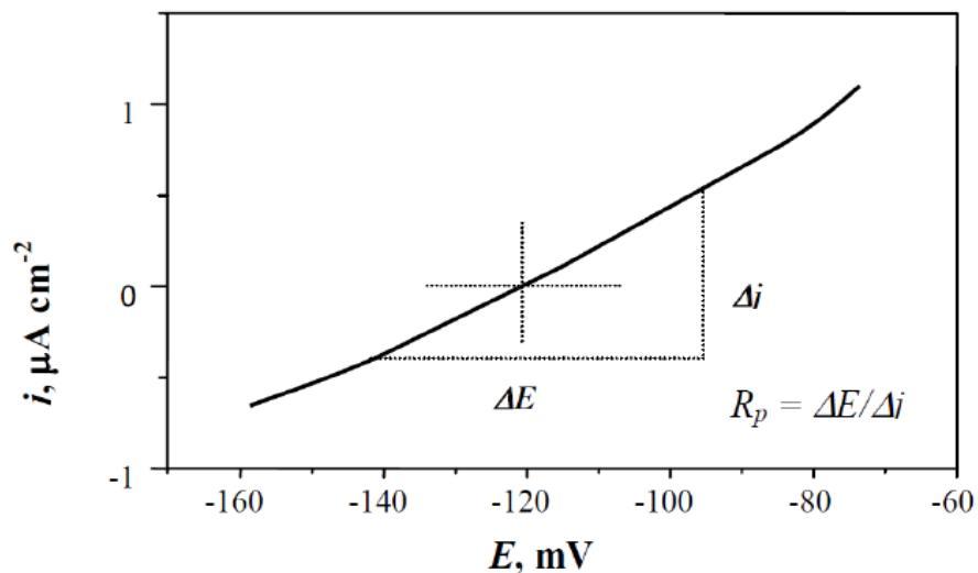
Slika 11. Određivanje polarizacijskog otpora metodom linearne polarizacije<sup>(29)</sup>
