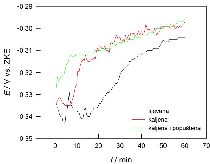
**Slika 19.** Promjene vrijednosti potencijala otvorenog strujnog kruga za CuAlMn leguru u 0,1% NaCl otopini pri  $37^{\circ}\text{C}$  i  $\text{pH} = 7,4$
