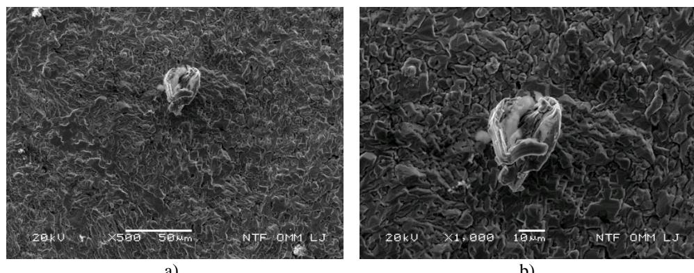
**Slika 37.** SEM snimka površine CuAlMn legure (lijevano stanje) nakon potenciodinamičkog polarizacijskog mjerena u 0,1 % NaCl otopini ( $pH = 7,4$   $T = 37^{\circ}C$ ) uz uvećanje 500 puta a) i 1000 puta b)
