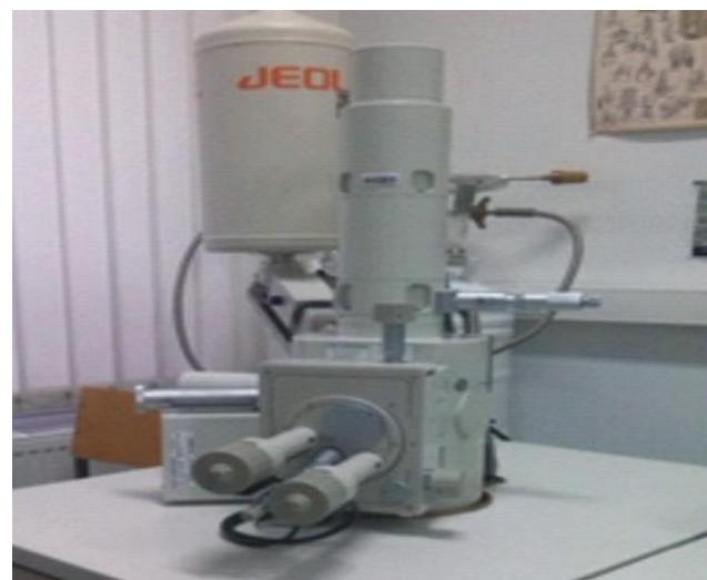
**Slika 18.** Pretražni elektronski mikroskop JEOL JSM-5610
