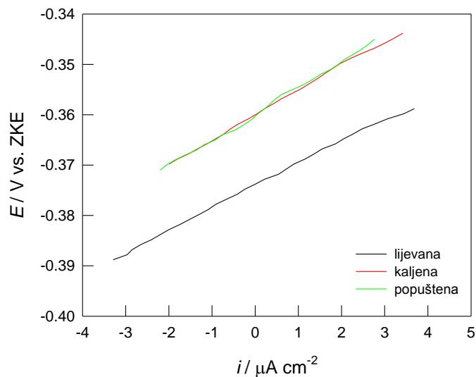
**Slika 24.** Linearni djelovi krivulja linearne polarizacije za CuAlMn leguru u 1,5% NaCl otopini pri  $37^{\circ}\text{C}$  i  $\text{pH} = 7,4$ .
