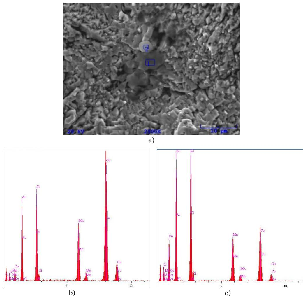
Slika 43. a) SEM snimka površine CuAlMn legure (lijevano stanje) nakon potenciodinamičkog polarizacijskog mjerena u 0,9 % NaCl otopini ( $\text{pH} = 7,4$   $T = 37^\circ\text{C}$ ) uz uvećanje 2500 puta i rezultati EDS analize za poziciju 1 a) i poziciju 2 b)
