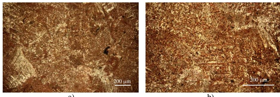
**Slika 28.** Mikroskopska snimka površine CuAlMn legure (lijevano stanje) nakon potenciodinamičkog polarizacijskog mjerena u 0,1 % NaCl otopini uz uvećanje a) 100 puta i b) 200 puta
