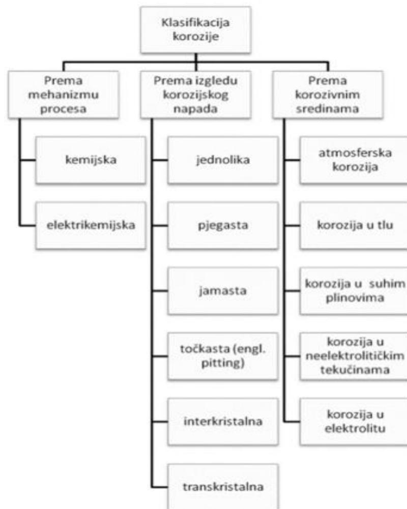
Slika 10. Klasifikacija korozije.<sup>(20)</sup>
