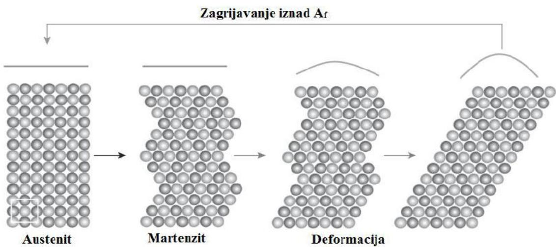
Slika 4. Mehanizam efekta prisjetljivosti oblika<sup>(12)</sup>
