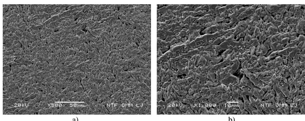
**Slika 39.** SEM snimka površine CuAlMn legure (kaljeno i popušteno stanje) nakon potenciodinamičkog polarizacijskog mjerena u 0,1 % NaCl otopini ( $pH = 7,4$   $T = 37^{\circ}C$ ) uz uvećanje 500 puta a) i 1000 puta b)
