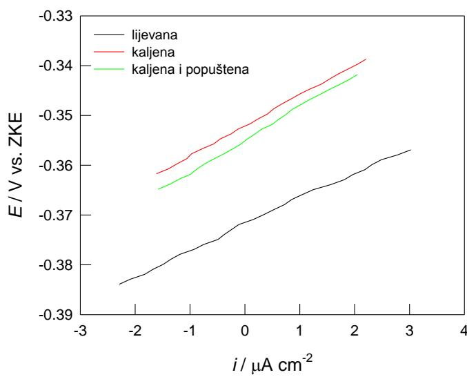
**Slika 23.** Linearni djelovi krivulja linearne polarizacije za CuAlMn leguru u 0,9% NaCl otopini pri 37 °C i pH = 7,4.
