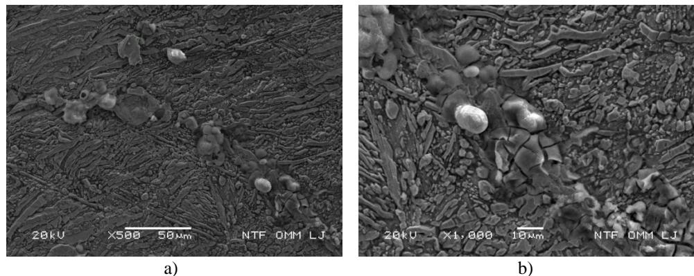
**Slika 41.** SEM snimka površine CuAlMn legure (kaljeno stanje) nakon potenciodinamičkog polarizacijskog mjerena u 0,9 % NaCl otopini ( $\text{pH} = 7,4$   $T = 37^\circ\text{C}$ ) uz uvećanje 500 puta a) i 1000 puta b)
