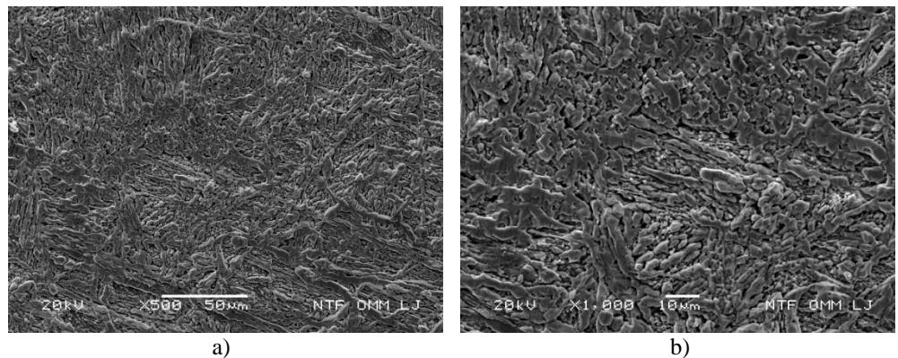
**Slika 42.** SEM snimka površine CuAlMn legure (kaljeno i popušteno stanje) nakon potenciodinamičkog polarizacijskog mjerena u 0,9 % NaCl otopini ( $\text{pH} = 7,4$   $T = 37^\circ\text{C}$ ) uz uvećanje 500 puta a) i 1000 puta b)
