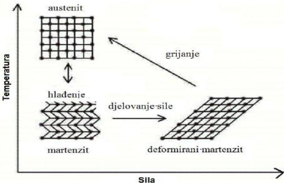
Slika 2. Ciklus promjena strukture za SMA legure<sup>(9)</sup>
