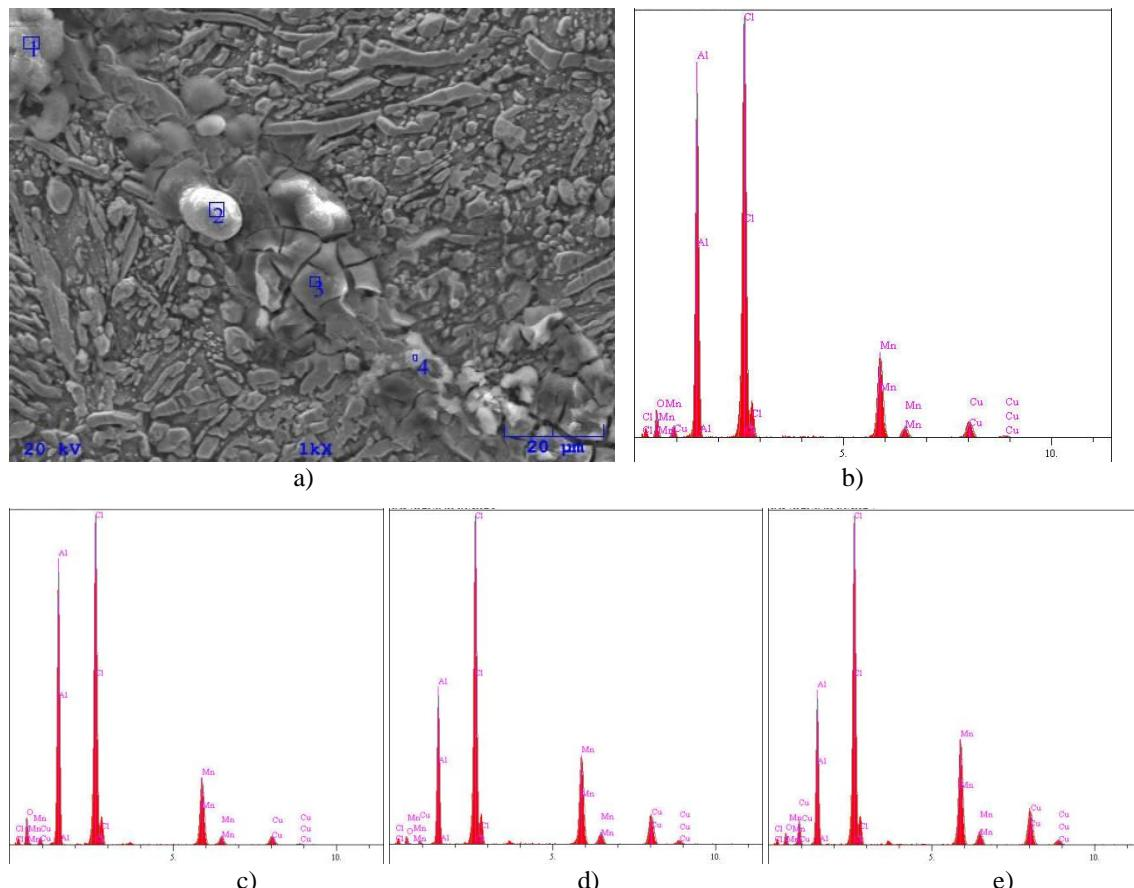
**Slika 44 .a)** SEM snimak površine CuAlMn legure (kaljeno stanje) nakon potenciodinamičkog polarizacijskog mjerjenja u 0,9 % NaCl otopini (pH = 7,4 T = 37 °C) uz uvećanje 2500 puta i rezultati EDS analize za poziciju 1 b), poziciju 2 c), poziciju 3 d) i poziciju 4 e)
