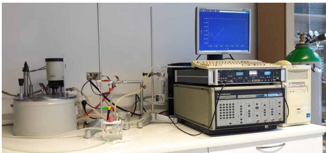
*Slika 16. Aparatura za provedbu elektrokemijskih mjerjenja.*
