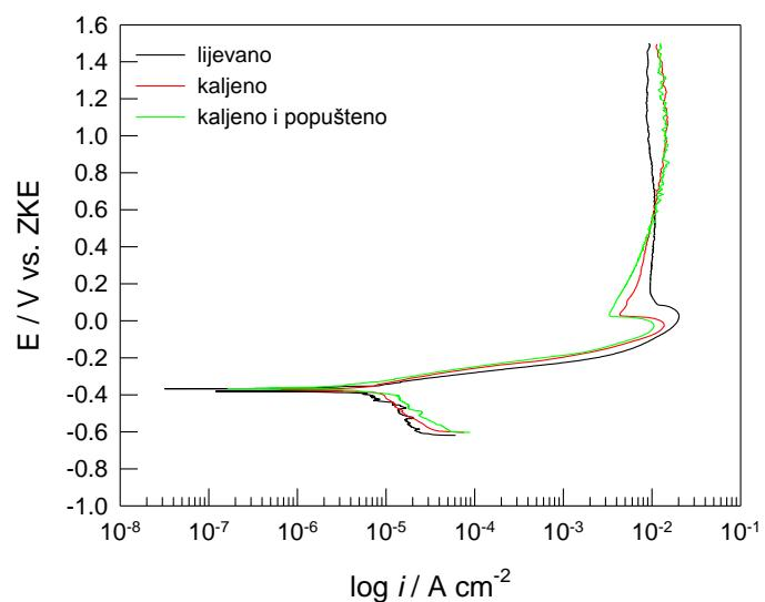
**Slika 27.** Potenciodynamičke polarizacijske krivulje za CuAlMn leguru u 1,5% NaCl otopini pri  $37^{\circ}\text{C}$  i  $\text{pH} = 7,4$
