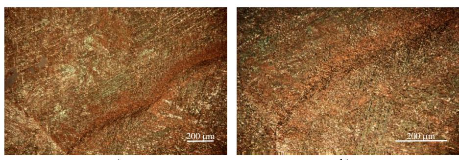
**Slika 30.** Mikroskopska snimka površine CuAlMn legure (kaljeno i popušteno stanje) nakon potenciodinamičkog polarizacijskog mjerena u 0,1 % NaCl otopini uz uvećanje a) 100 puta i b) 200 puta
