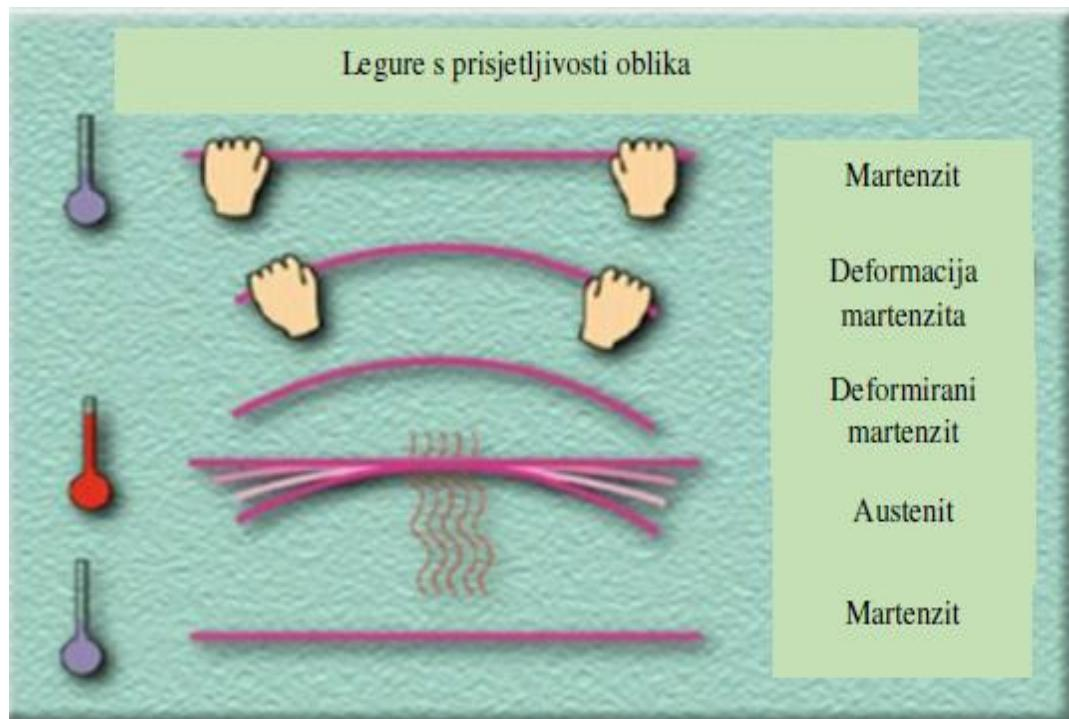
Slika 1. Transformacija legura s efektom prisjetljivosti oblika<sup>(8)</sup>
