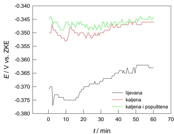
**Slika 20.** Promjene vrijednosti potencijala otvorenog strujnog kruga za CuAlMn leguru u 0,9% NaCl otopini pri  $37^{\circ}\text{C}$  i  $\text{pH} = 7,4$ .
