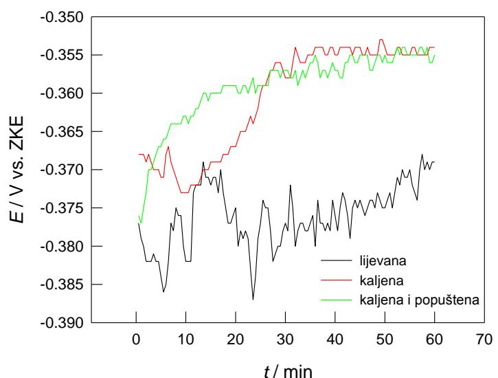
**Slika 21.** Promjene vrijednosti potencijala otvorenog strujnog kruga za CuAlMn leguru u 1,5% NaCl otopini pri  $37^{\circ}\text{C}$  i  $\text{pH} = 7,4$
