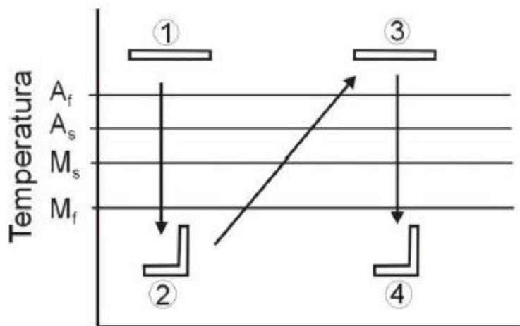
Slika 6. Shematski prikaz dvozmjernog efekta prisjetljivosti oblika<sup>(3)</sup>
