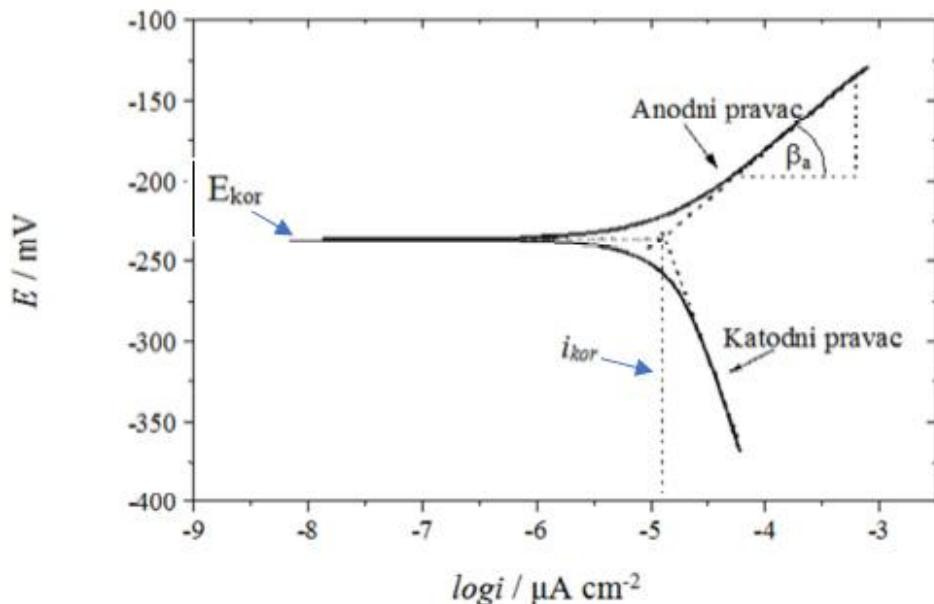
**Slika 12.** Tafelova metoda određivanja korozijskih parametara iz polarizacijskih mjerena<sup>(32)</sup>
