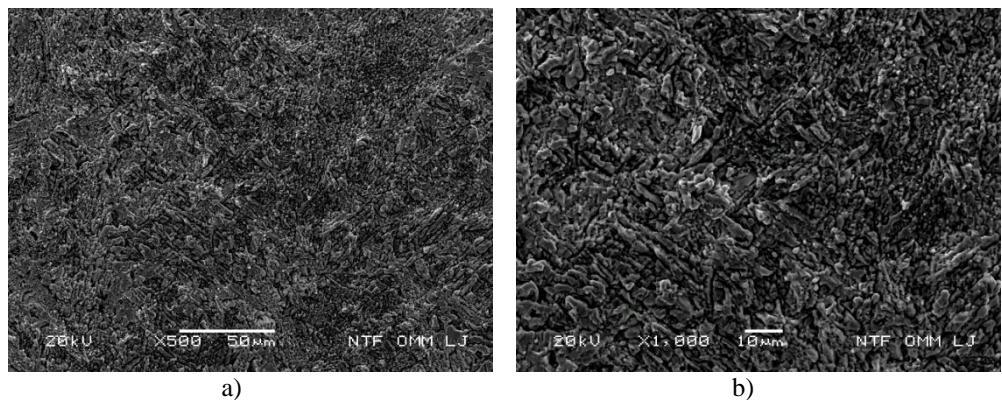
**Slika 40.** SEM snimka površine CuAlMn legure (lijevano stanje) nakon potenciodinamičkog polarizacijskog mjerena u 0,9 % NaCl otopini ( $\text{pH} = 7,4$   $T = 37^\circ\text{C}$ ) uz uvećanje 500 puta a) i 1000 puta b)
