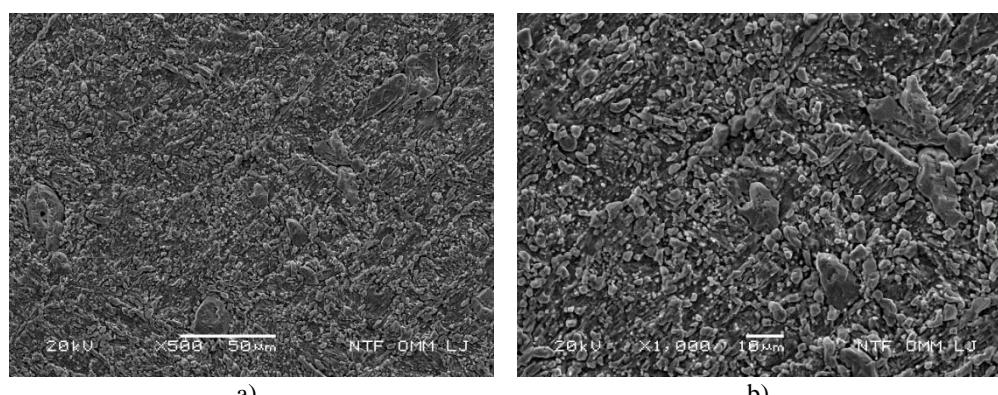
**Slika 38.** SEM snimka površine CuAlMn legure (kaljeno stanje) nakon potenciodinamičkog polarizacijskog mjerena u 0,1 % NaCl otopini ( $pH = 7,4$   $T = 37^{\circ}C$ ) uz uvećanje 500 puta a) i 1000 puta b)
