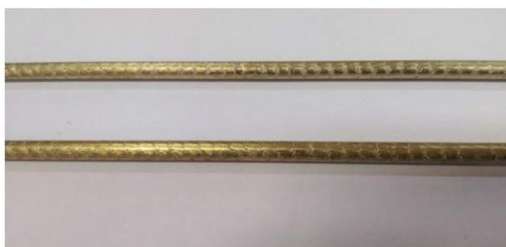
**Slika 13.** Fotografija cilindričnih šipki CuAlMn legure proizvedenih kontinuiranim vertikalnim lijevanjem<sup>(33)</sup>
