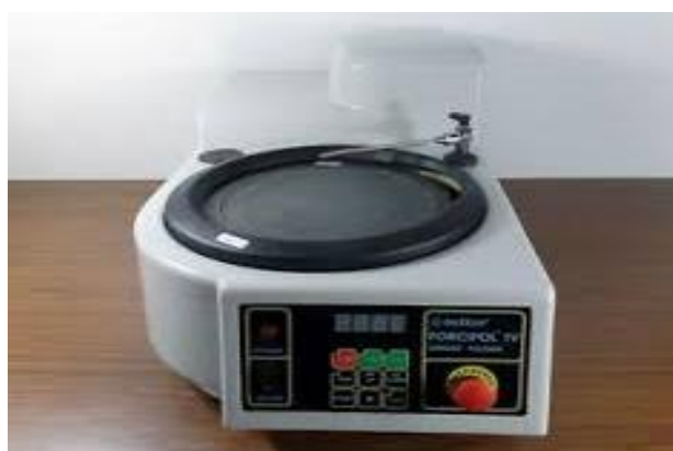
Slika 15. Uređaj za brušenje i poliranje Metkon Forcipol 1V
