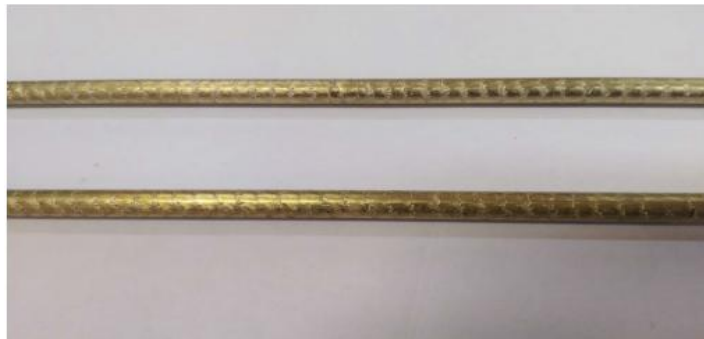
Slika 13. Fotografija cilindričnih šipki CuAlMn legure proizvedenih kontinuiranim vertikalnim lijevanjem (33)
