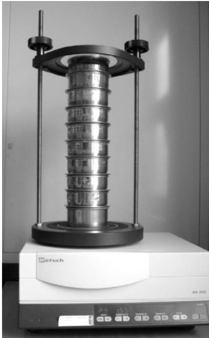
Slika 19. Aparatura za provedbu granulometrijske analize prosijavanjem i svjetlosni mikroskop
