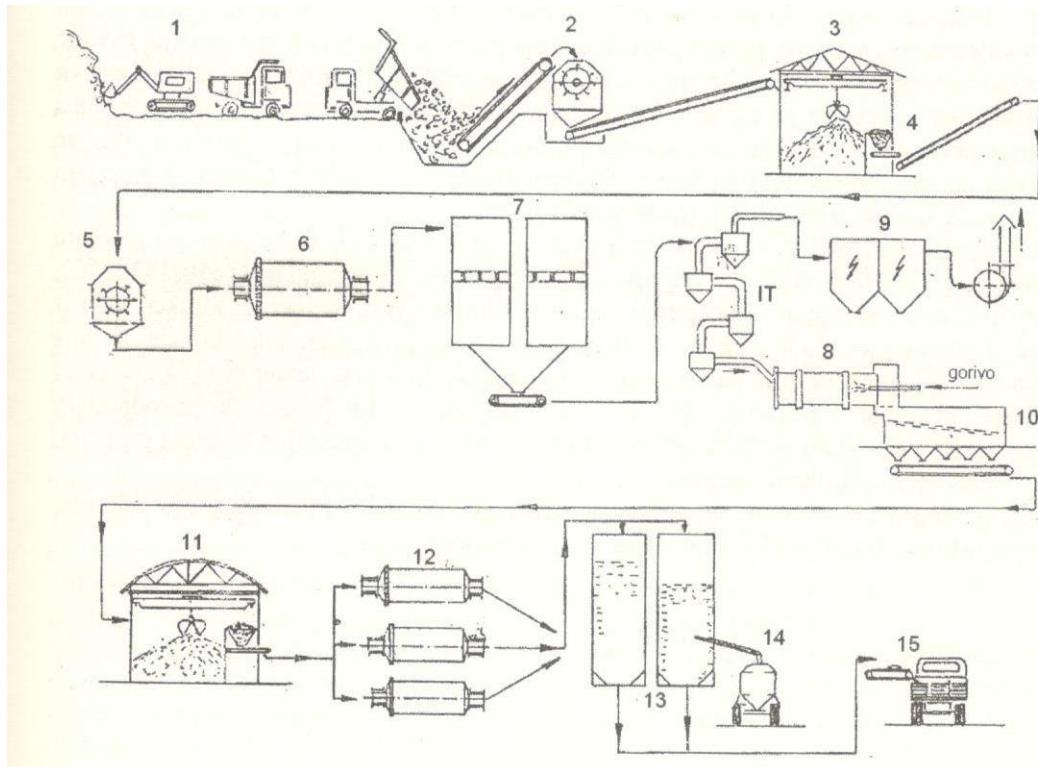
Slika 1. Shema procesa proizvodnje Portland-cementna, suhi postupak<sup>1</sup>
