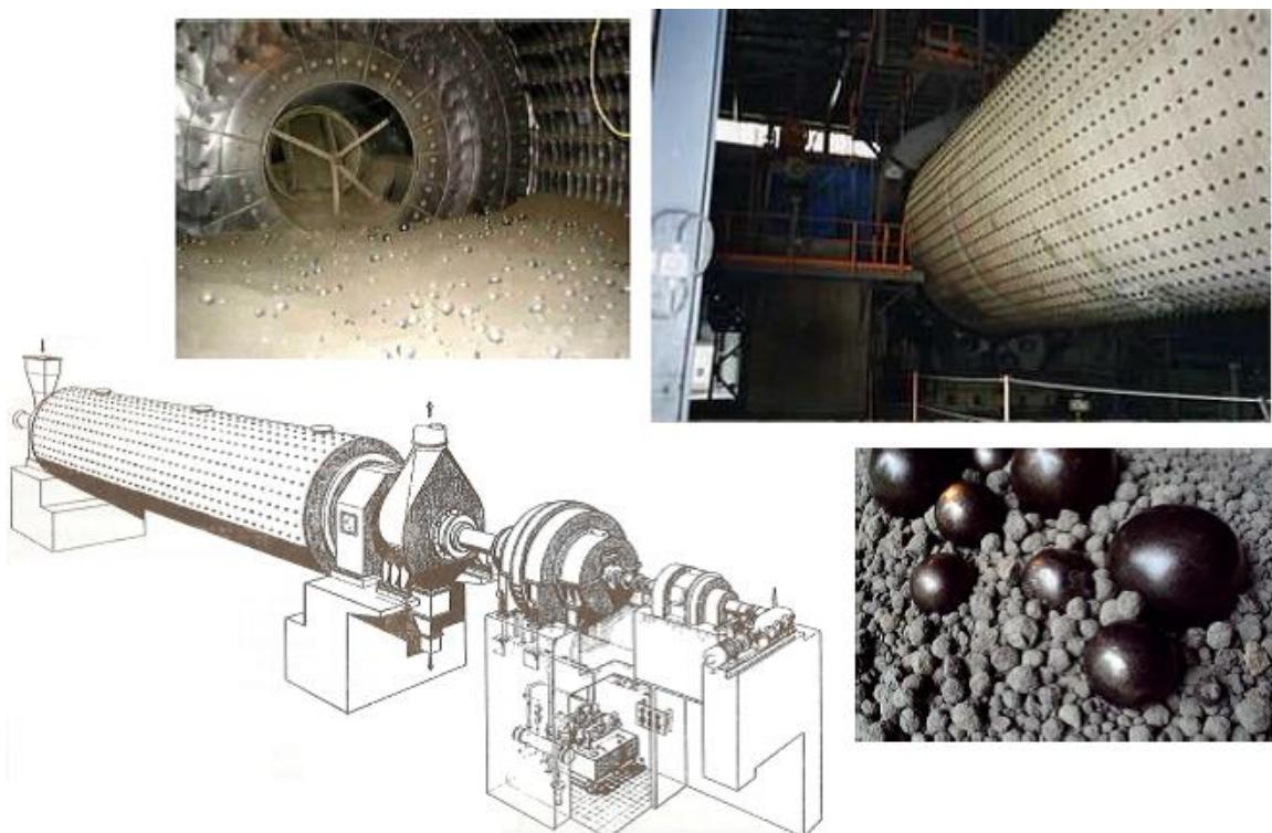
Slika 2. Kuglični mlin za mljevenje portlandskog cementa<sup>2</sup>
