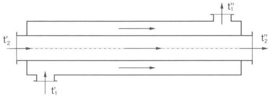
Slika 7. Istosmjerni tip rekuperatora<sup>4</sup>
