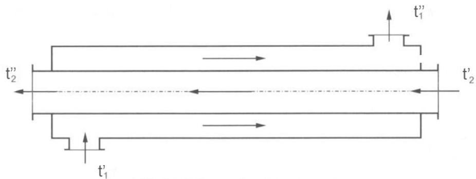
Slika 8. Protusmjerni tip rekuperatora<sup>4</sup>
