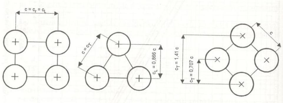
Slika 13. Raspored i korak cijevi u cjevnom snopu<sup>6</sup>
