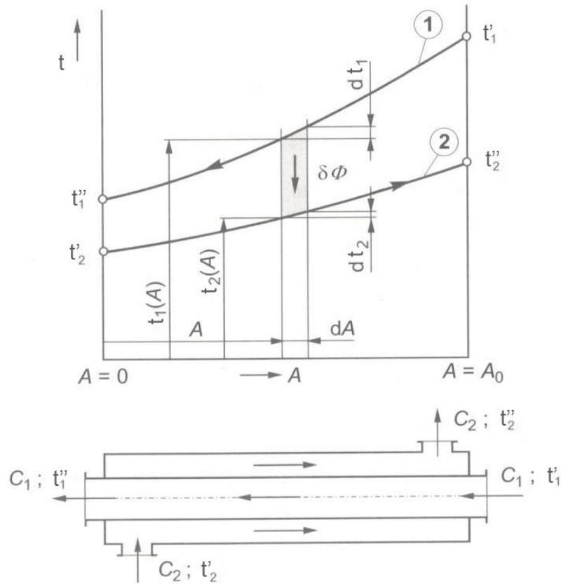
Slika 11. Temperaturni tok struja uzduž protusmjernog izmjenjivača<sup>4</sup>
