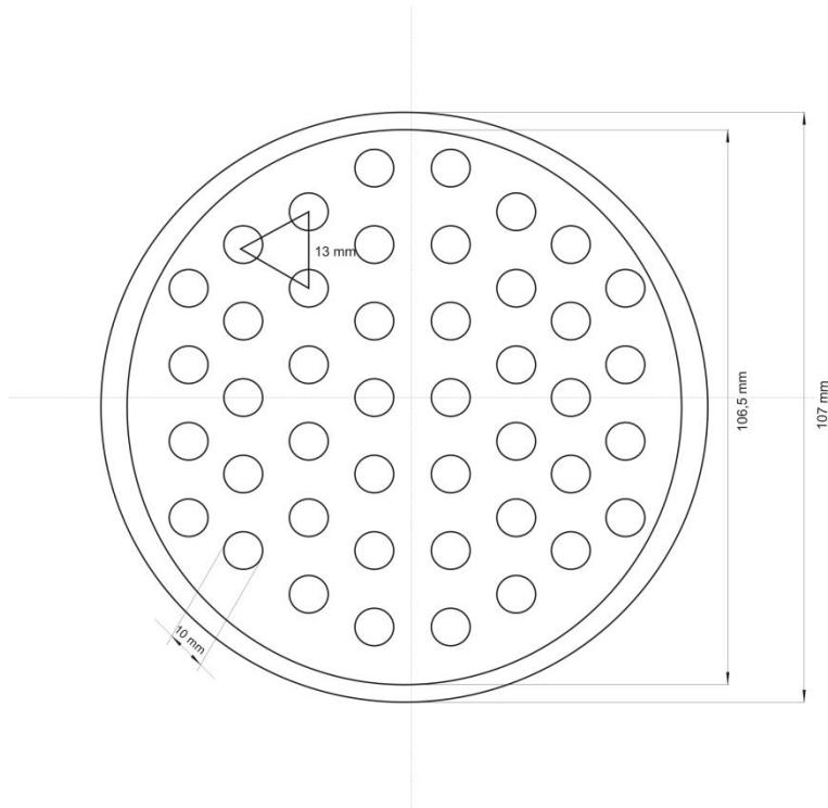
Slika 14. Raspored cijevi u cijevnom snopu 1-2 tipa izmjenjivača
