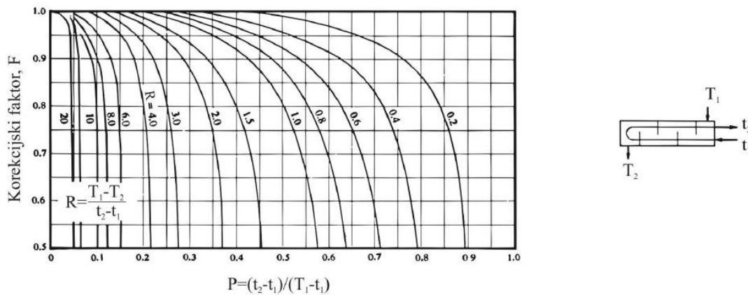
Slika 12. Dijagram ovisnosti<sup>6</sup>  $F = f(P, R)$  za protusmjerni izmjenjivač tipa 1-2
