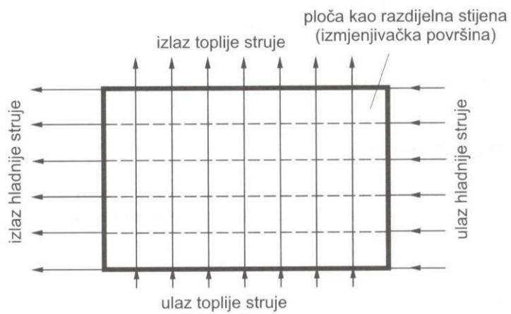
Slika 9. Unakrsni tip rekuperatora<sup>4</sup>
