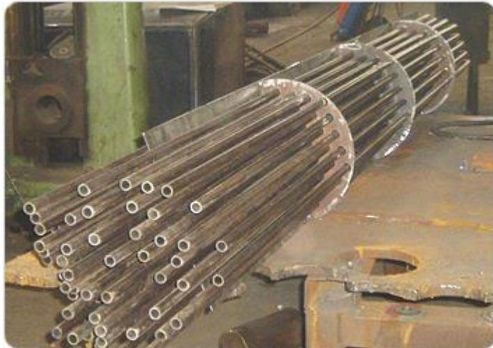
Slika 4. Cijevni snop u fazi izrade cijevnog izmjenjivača topline<sup>9</sup>
