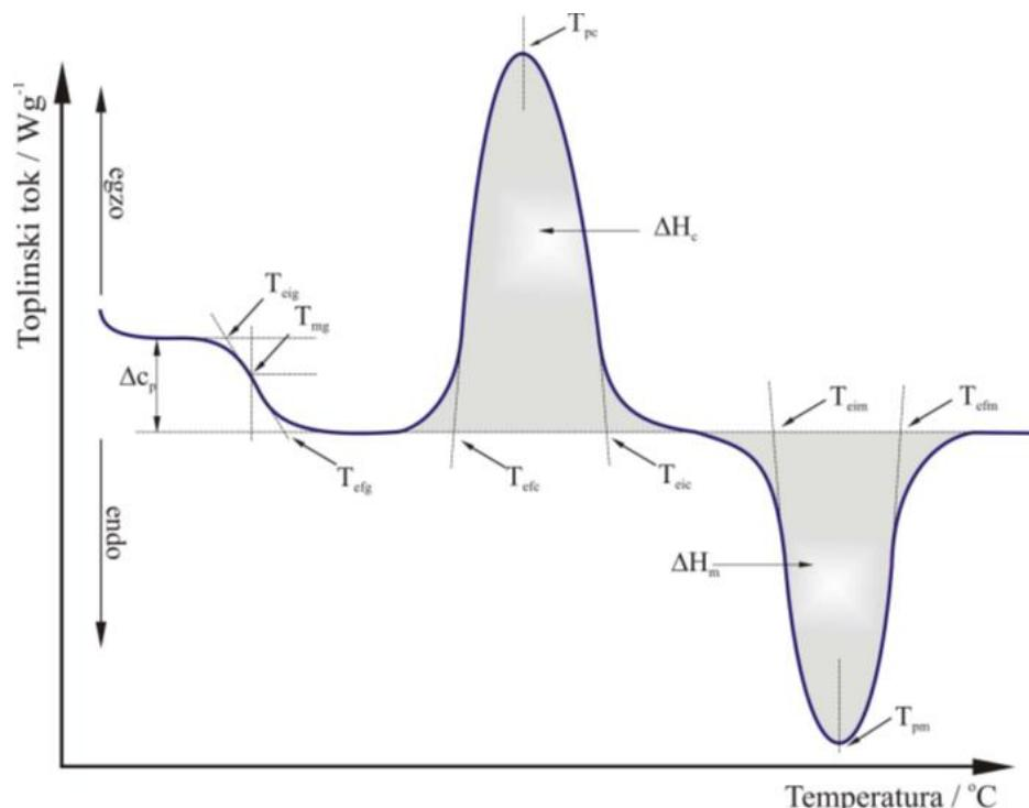
Slika 8. Određivanje značajki krivulje diferencijalne pretražne kalorimetrije u inertu<sup>11</sup>
