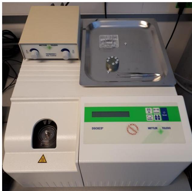
Slika 10. Diferencijalni pretražni kalorimetar DSC 823<sup>e</sup>(Mettler Toledo)
