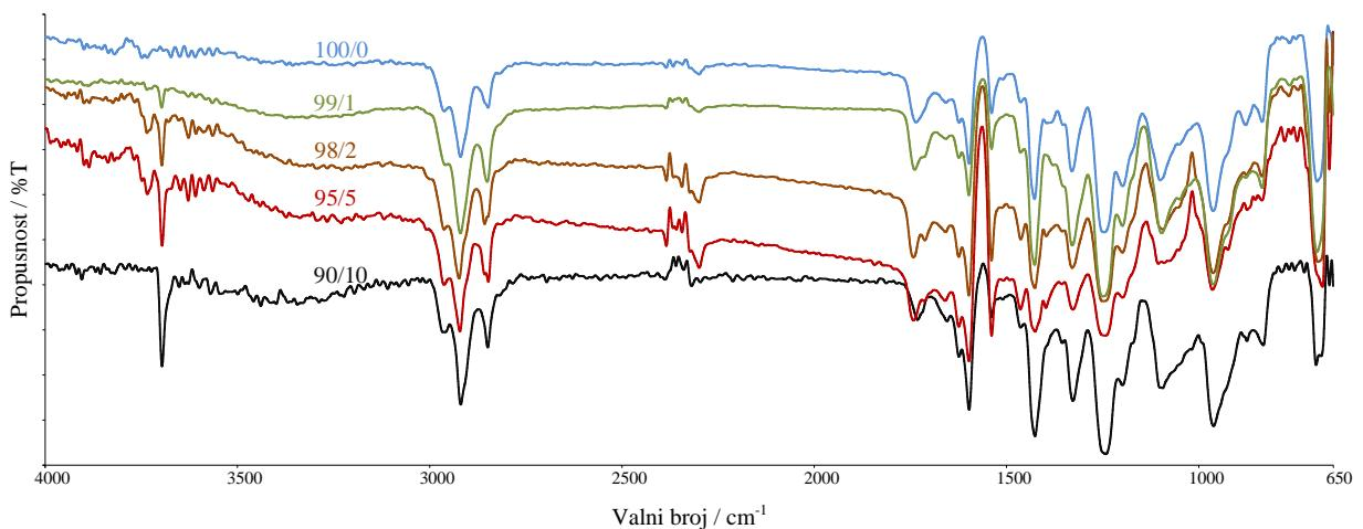
Slika 23. FT-IR spektri mješavina PVC/MH
