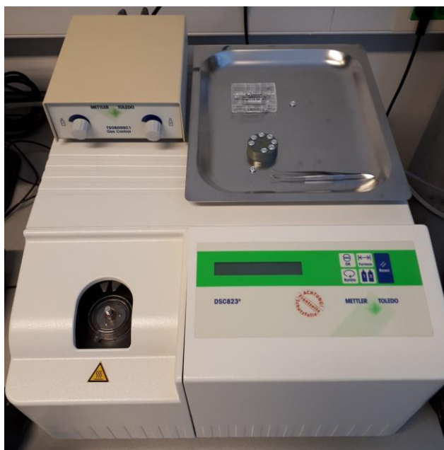
Slika 10. Diferencijalni pretražni kalorimetar DSC 823 e (Mettler Toledo)
