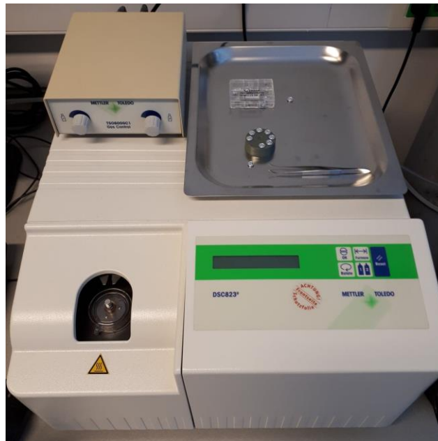
Slika 10. Diferencijalni pretražni kalorimetar DSC 823 e (Mettler Toledo)
