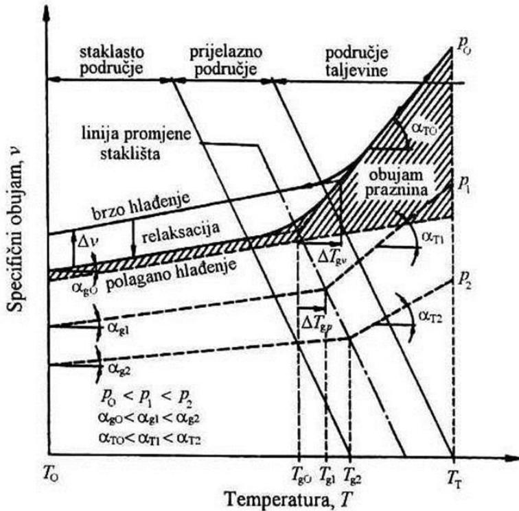
Slika 2. Temperaturna ovisnost specifičnog obujma amorfognog plastomera o temperaturi pri različitim tlakovima.<sup>16</sup>
