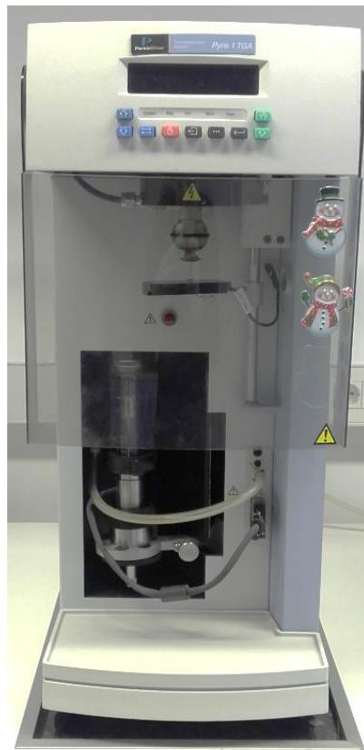
Slika 5. Aparatura za termogravimetrijsku analizu Pyris 1 TGA (Perkin-Elmer)
