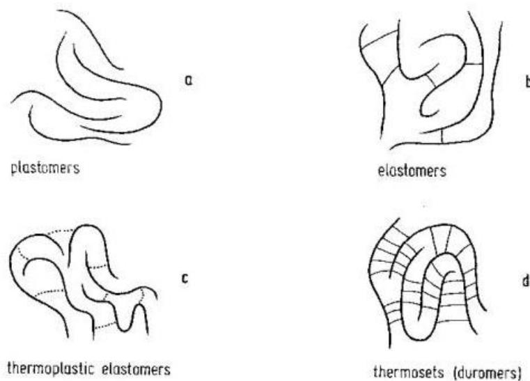
Slika 1. Konfiguracija polimera: a) plastomeri; b) elastomeri; c) elastoplastomeri; d) duromeri<sup>8</sup>
