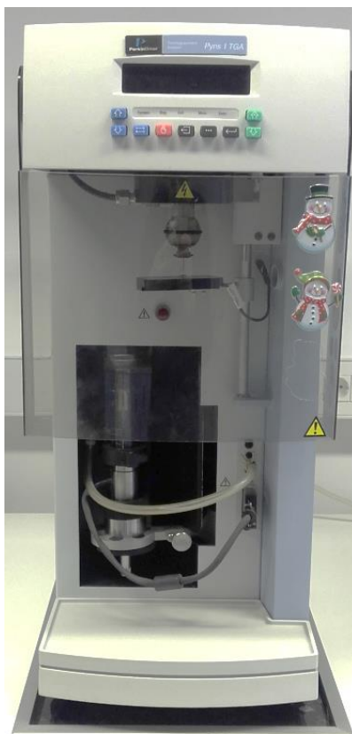
Slika 5. Aparatura za termogravimetrijsku analizu Pyris 1 TGA (Perkin-Elmer)
