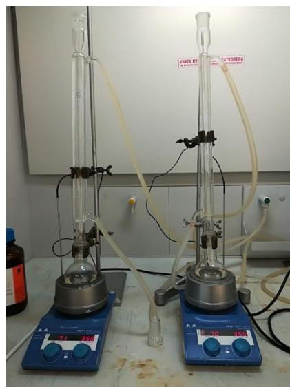
**Slika 15.** Aparatura za refluksiranje uzoraka PEO/fenil hib-POSS
