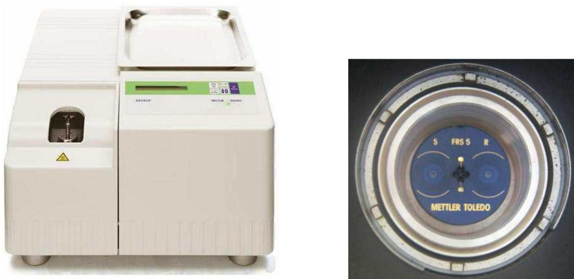
Slika 18. a) Diferencijalni pretražni kalorimetar DSC 823<sup>e</sup> (Mettler Toledo, Švicarska)
