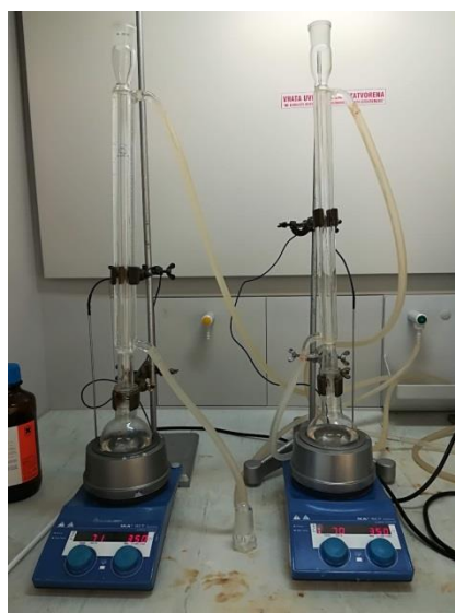
Slika 15. Aparatura za refluksiranje uzoraka PEO/fenil hib-POSS
