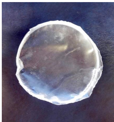
Slika 15. Folija PEO/fenil hib-POSS dobivena metodom iz otopine
