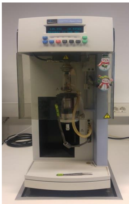
Slika 21. Aparatura za termogravimetrijsku analizu Pyris 1 TGA (Perkin-Elmer)
