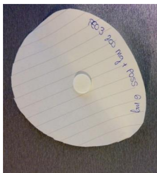
Slika 19. Uzorak PEO/fenil hib-POSS 97/3 Slika 20. Uzorak PEO/fenil hib-POSS 95/5
