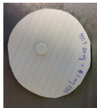
Slika 17. Uzorak PEO/fenil hib-POSS 100/0 Slika 18. Uzorak PEO/fenil hib-POSS 99/1
