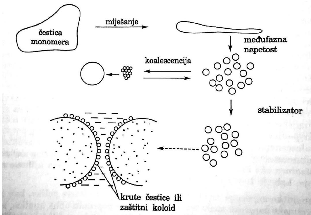
Slika 2. Stabilizacija čestica u procesu suspenzijske polimerizacije<sup>1</sup>
