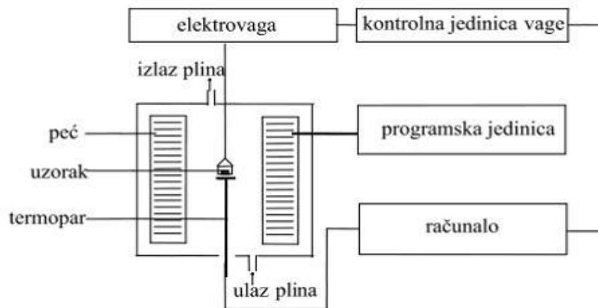
Slika 15. Shema termogravimetra<sup>30</sup>
