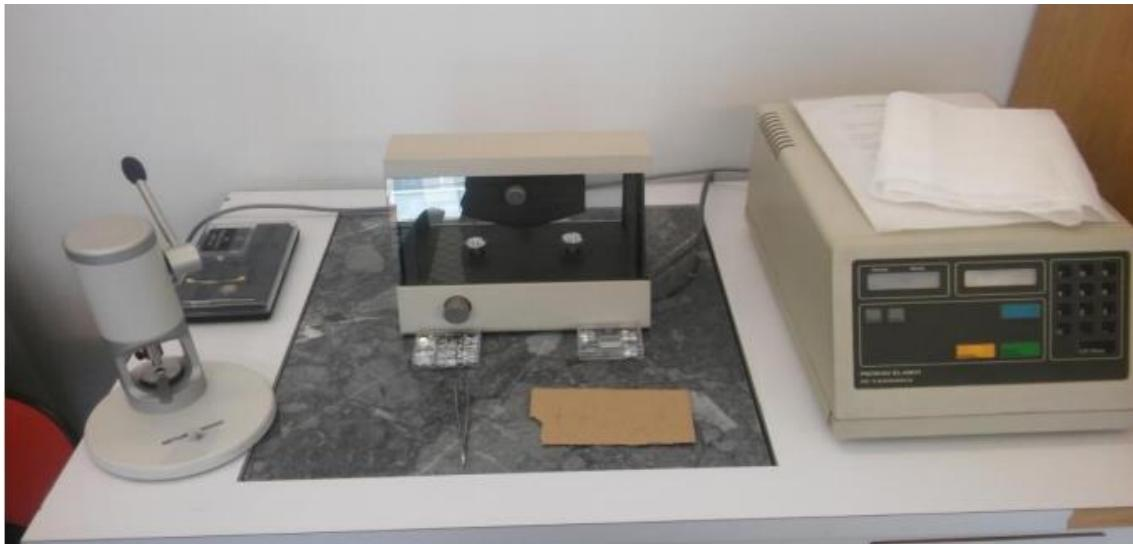
Slika 18. Ultramikrovaga i preša za zatvaranje aluminijskih posudica<sup>37</sup>
