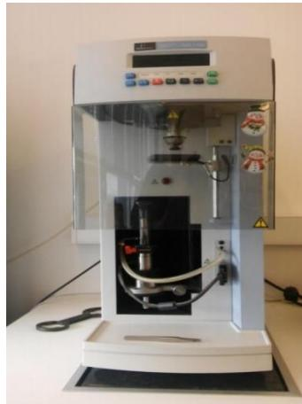
Slika 19. Termogravimetrijski uređaj<sup>37</sup>
