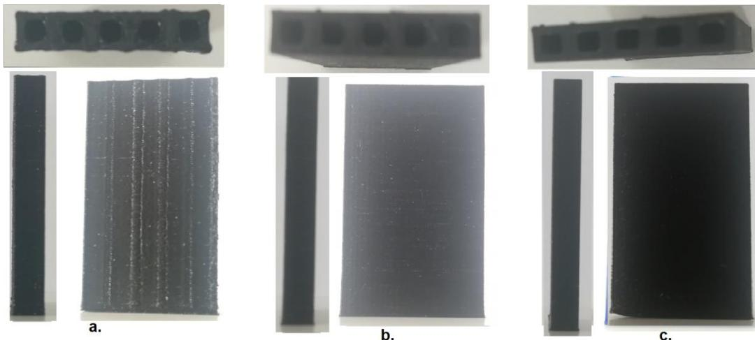
Slika 39. Izgled tiskanog modela CPE za brzinu a. 0,20, b. 0,10 i c. 0,06  $\text{mm}^3/\text{s}$
