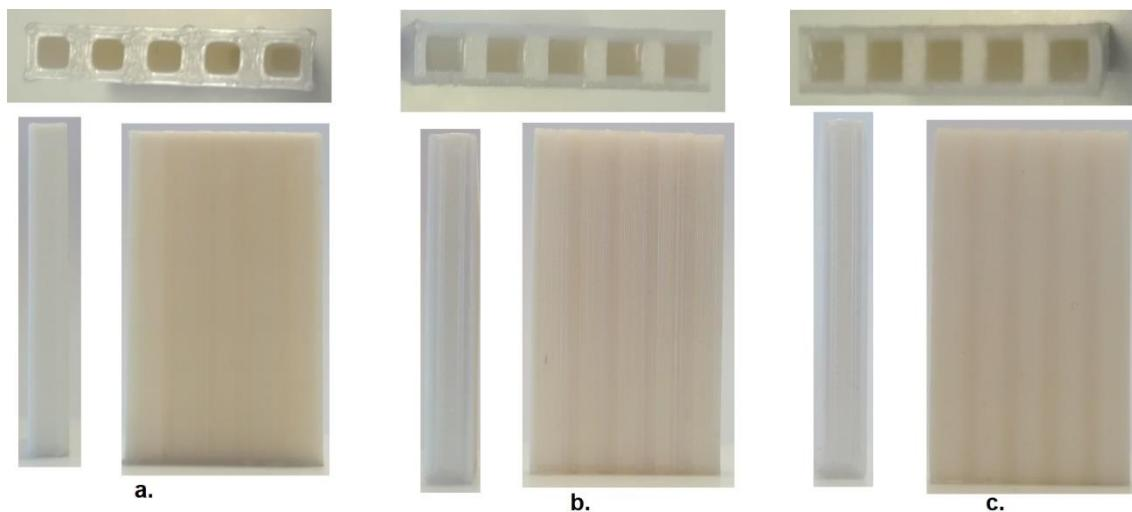
Slika 35. Izgled tiskanog modela PLA za brzinu a. 0,20, b. 0,10 i c. 0,06  $\text{mm}^3/\text{s}$
