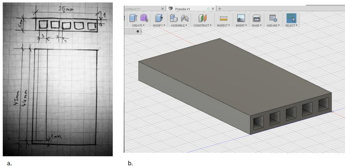
Slika 25. a. Dimenzije prototipa, b. Prototip u Autodesk Fusion 360<sup>37</sup>
