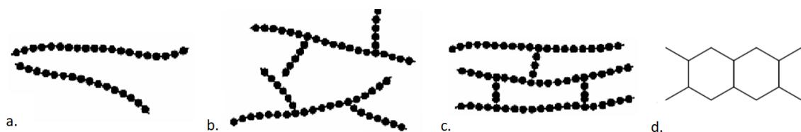
Slika 1. Shematski prikaz strukture a. linearne, b. granatne, c. umrežene, d. ljestvaste<sup>3</sup>
