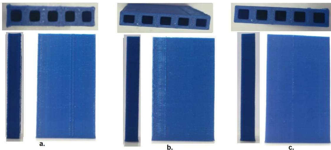
Slika 37. Izgled tiskanog modela ABS za brzinu a. 0,20, b. 0,10 i c. 0,06  $\text{mm}^3/\text{s}$
