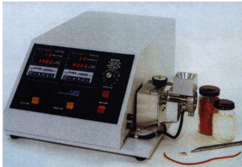
Slika 2.3. Jednpužni laboratorijski ekstruder Dynisco (Qualitest, Kanada)
