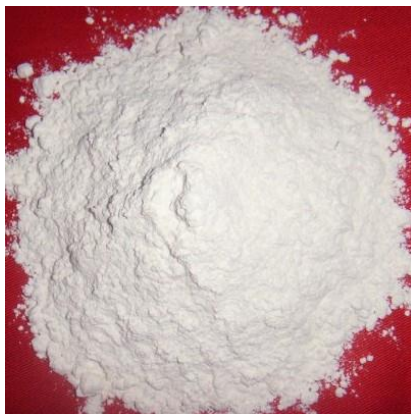
Slika 2.1. Magnezijev hidroksid površinski modificiran s 4, 6 i 8% stearinske kiseline
